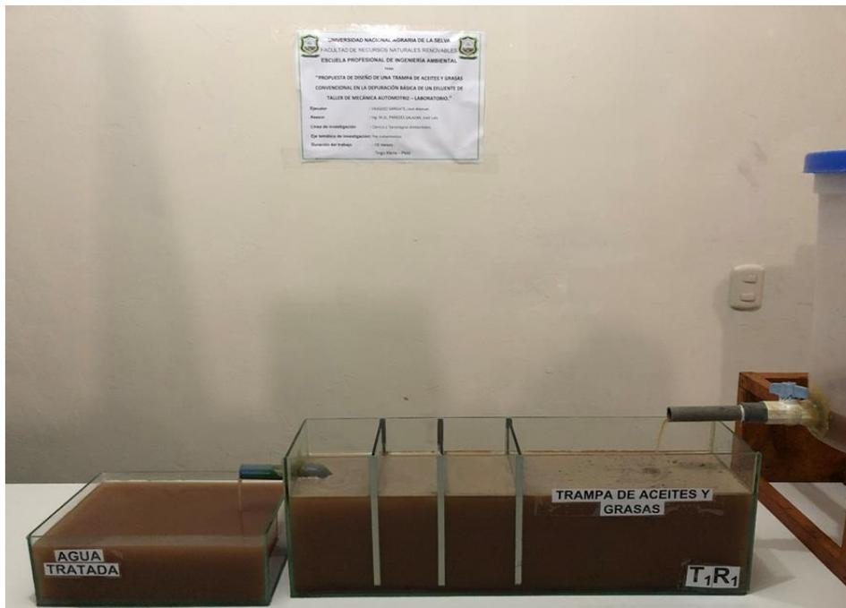
**Figura 24.** Visualización de la formación de las películas de aceite en los compartimentos..
