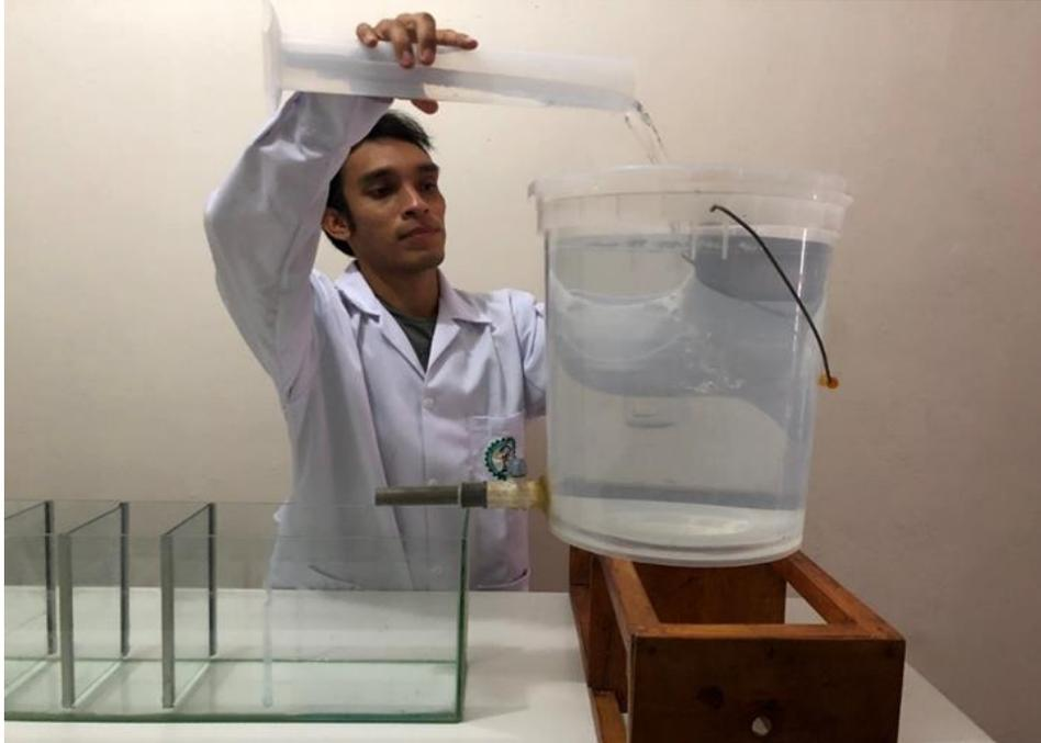
**Figura 13.** Rectificación del volumen del tanque de alimentación.
