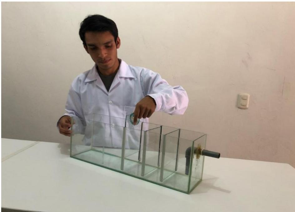
**Figura 8.** Revisión del ensamblaje y dimensiones de la trampa de aceites y grasas.
