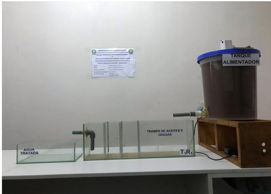
**Figura 5.** Caracterización de sistema experimental – inicio de los tratamientos.
