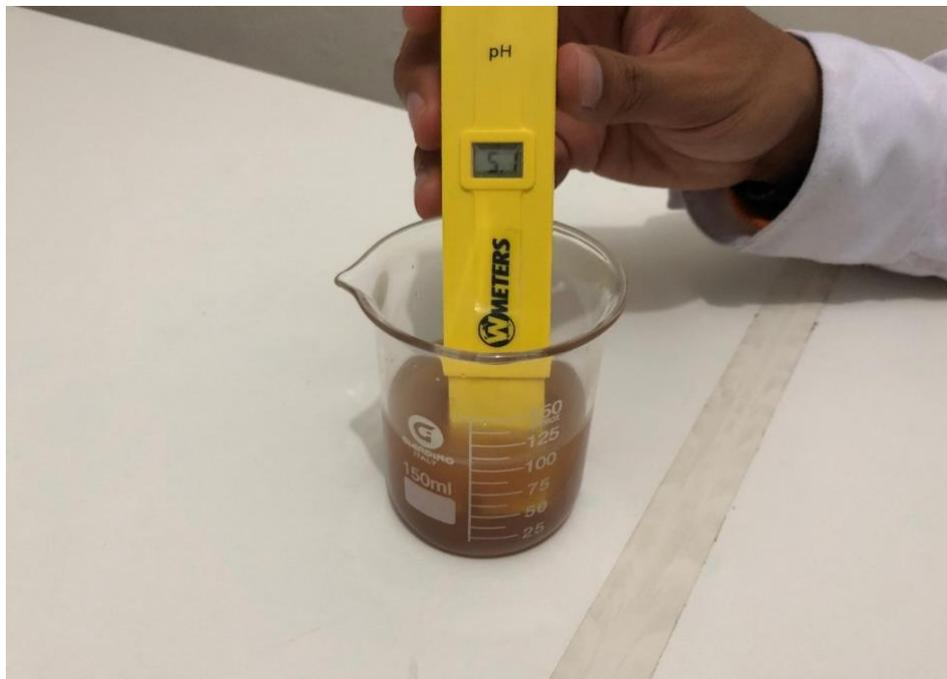
**Figura 28.** Medición del pH del agua a la salida del sistema experimental.
