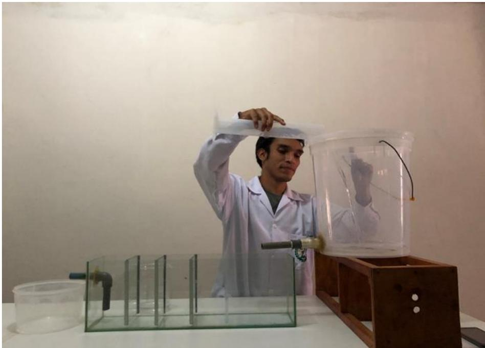
**Figura 12.** Verificación de volumen y hermeticidad de las partes del sistema experimental.
