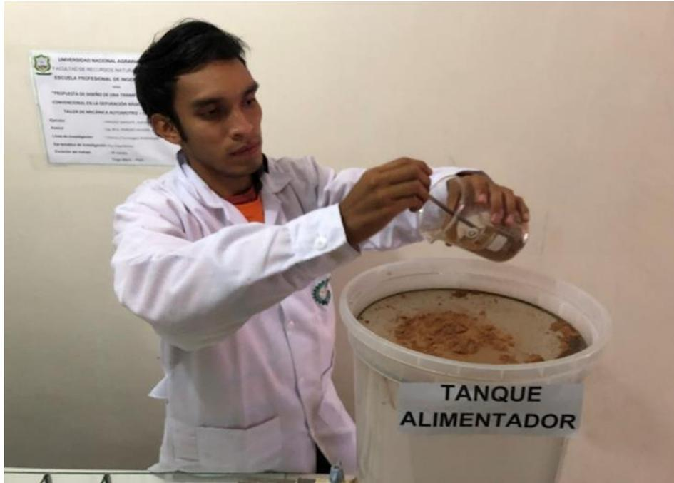
**Figura 17.** Complemento de la preparación del agua residual con adición de polvo de cacao.
