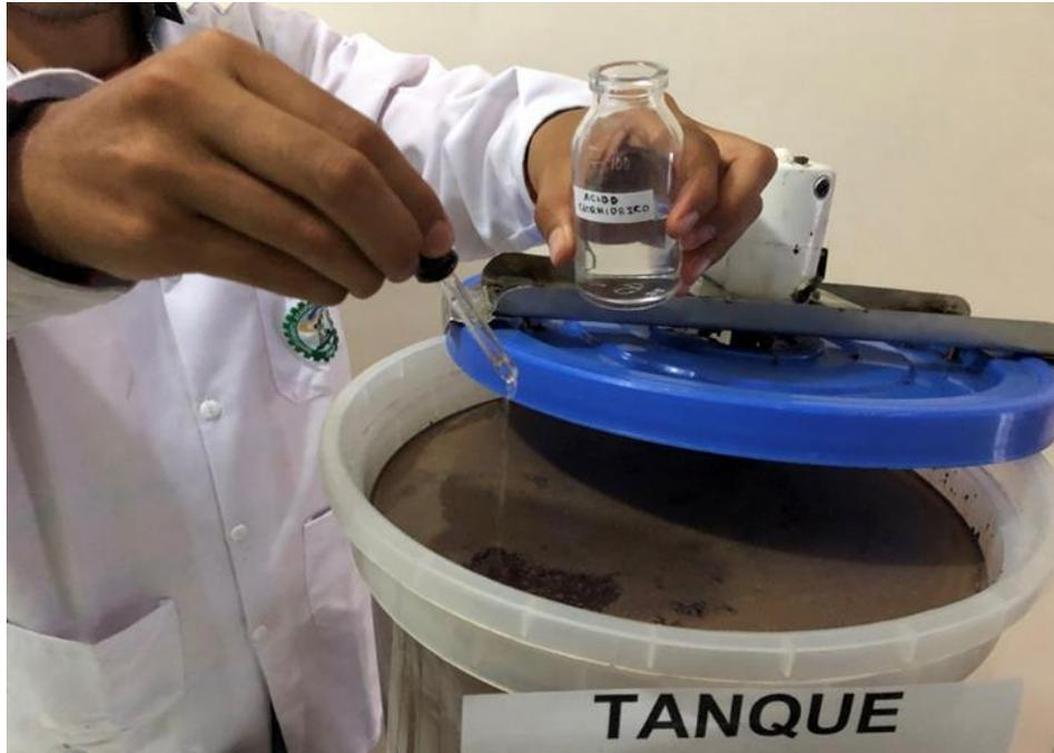
**Figura 19.** Adición de ácido clorhídrico para ajuste de pH.
