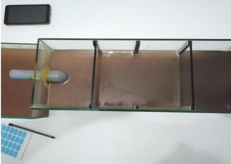
**Figura 25.** Vista en planta de la trampa de aceites y grasas, con formación de películas de aceite.
