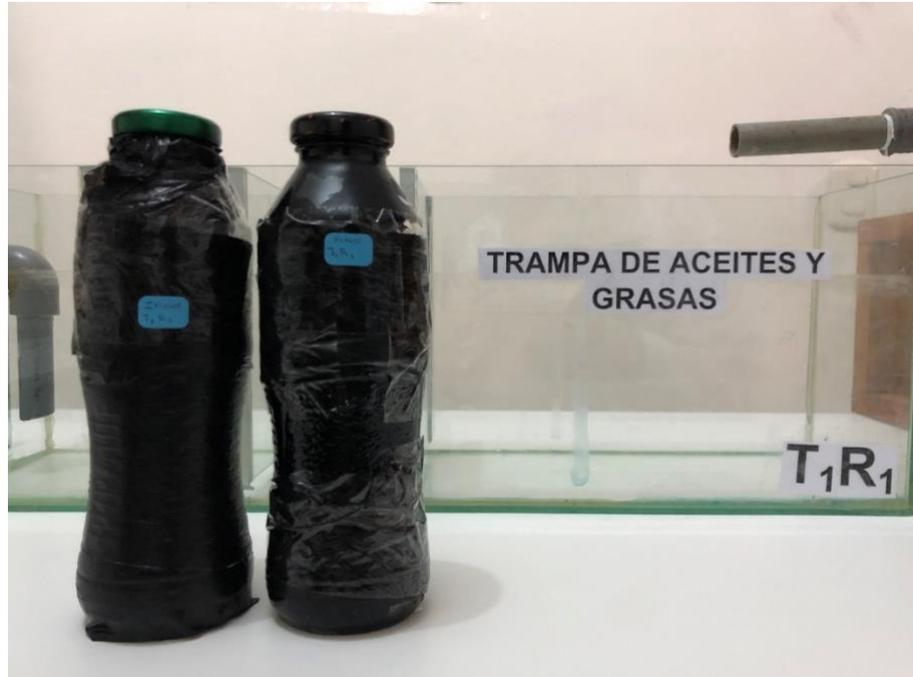
**Figura 33.** Muestras para análisis de DBO del agua residual.
