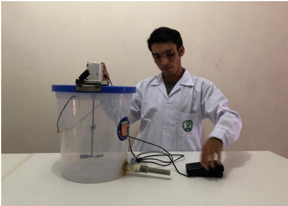
**Figura 10.** Revisión del funcionamiento del agitador de tanque de alimentación.
