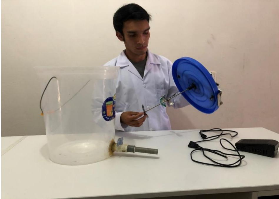
**Figura 9.** Revisión del montaje del agitador del tanque de alimentación.
