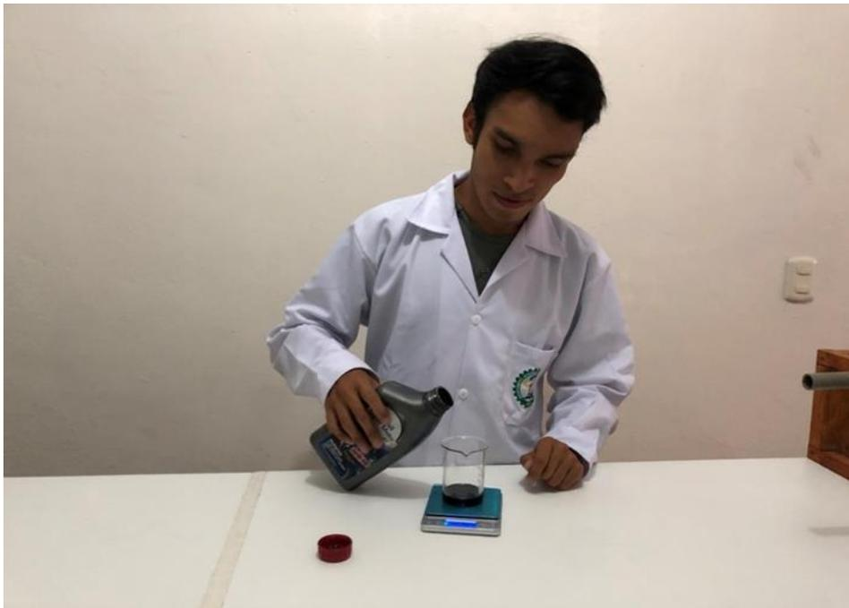
**Figura 14.** Medición del peso de aceite combustionado, recolectado en un taller de mecánica.
