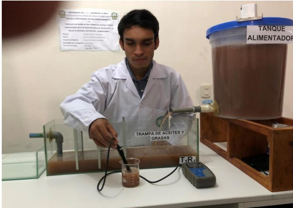
**Figura 29.** Medición del oxígeno disuelto durante la ejecución de los tratamientos.
