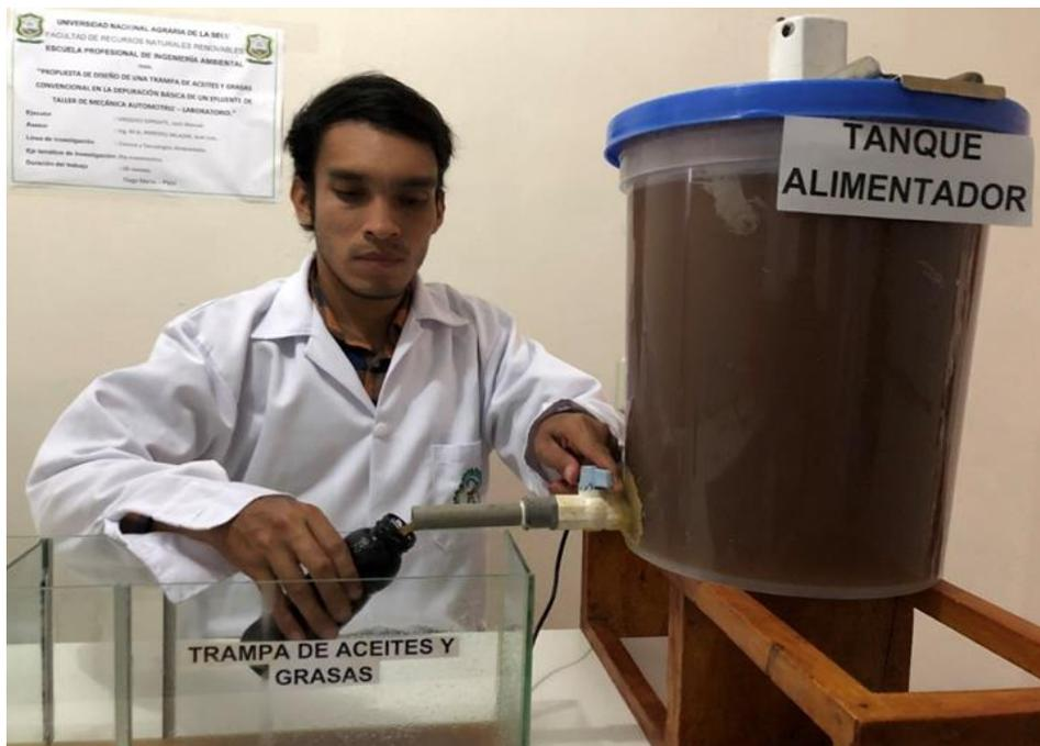
**Figura 26.** Toma de muestras iniciales para caracterización del agua residual.
