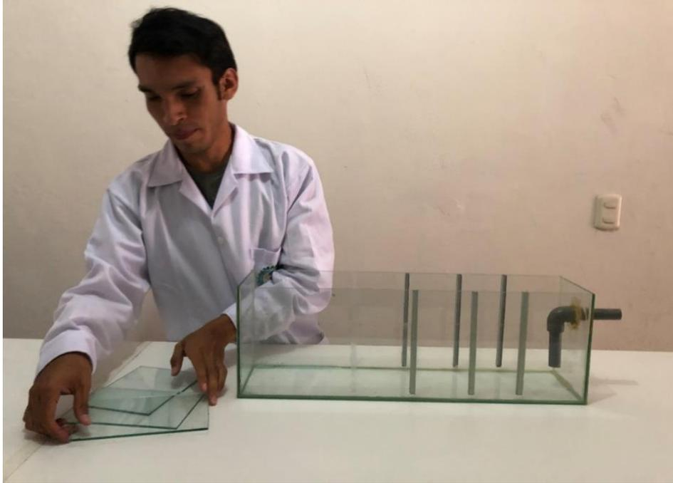
**Figura 7.** Revisión de los compartimentos de la trampa de aceites y grasas de la investigación.
