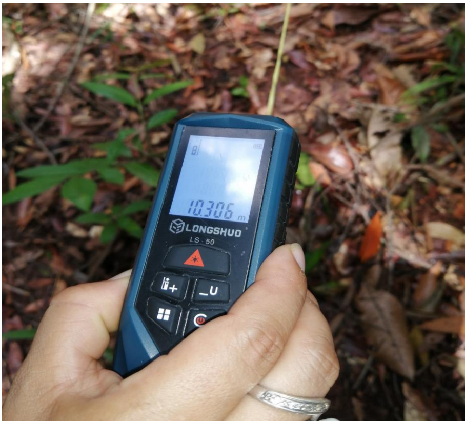
Figura 31. Medición de las distancias de la regeneración natural con distanciómetro laser
