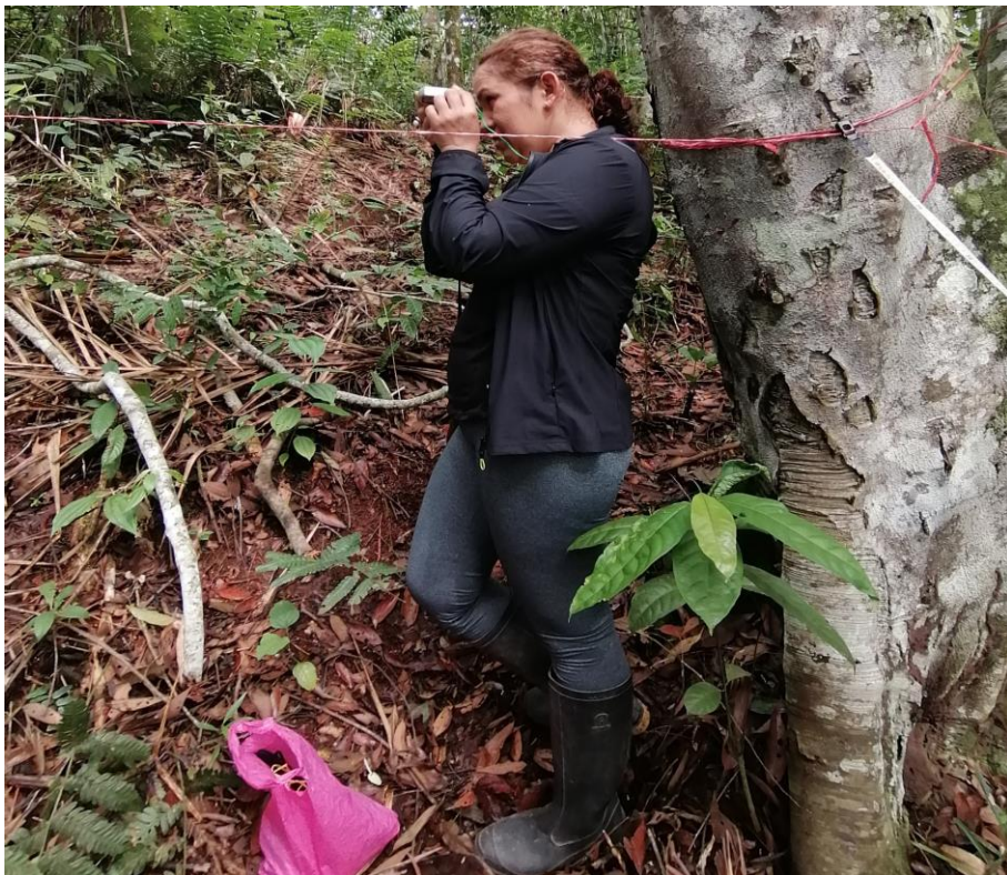
Figura 29. Medición del azimut de la regeneración natural desde el árbol padre
