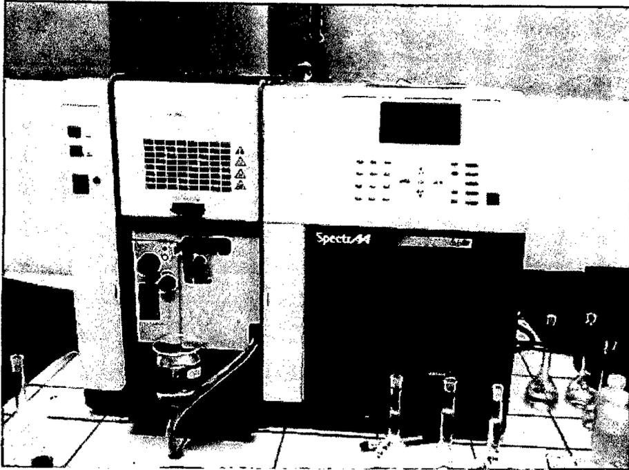
Figura 11. Espectrofotómetro del laboratorio de suelos de la facultad de Agronomía de la UNAS donde se realizó las lecturas
