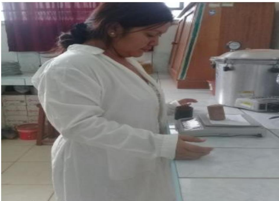
Figura 12. Pesado de la muestra para determinar la densidad aparente
