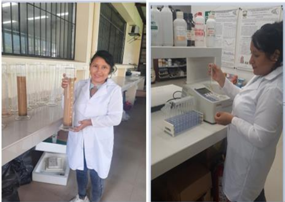
Figura 242. Determinado la textura del suelo y el porcentaje de aluminio de suelo
