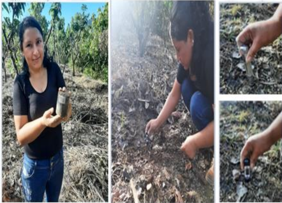
Figura 24. Tomando la muestra para determinar los parametros fisicos (densidad aparente, temperatura y la resistencia del suelo – insitu )
