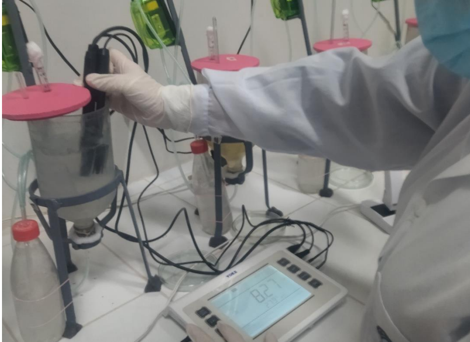
Figura 16. Medición de los parámetros fisicoquímicos al inicio, tercero y séptimo día de operación de los biorreactores Air Lift
