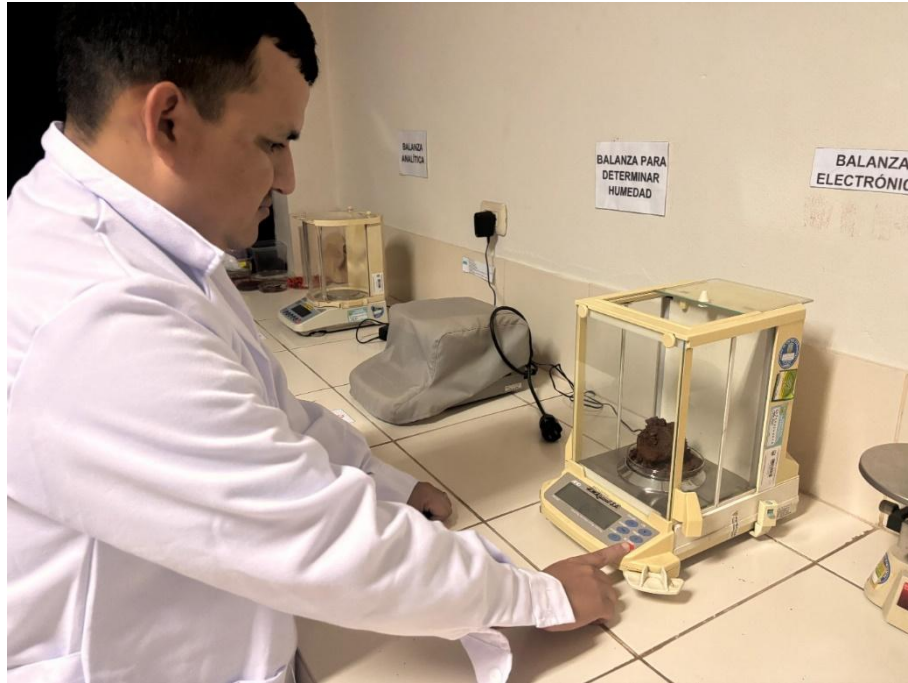
Figura 17. Pesaje de muestras de suelo en balanza analítica para la determinación de densidad aparente y carbono orgánico en el laboratorio.
