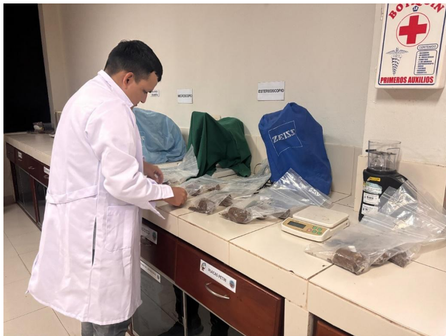
Figura 16. Preparación y registro de muestras de suelo en el Laboratorio de Análisis de Suelos de la UNAS para la determinación de carbono orgánico (método Walkley–Black).
