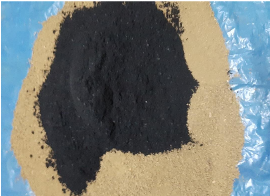
Figura 54. Preparación de la mezcla biocarbón-suelo en porcentaje de 6%, 8% y 10%.
