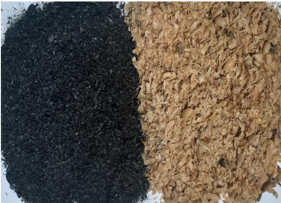
Figura 46. Biocarbón obtenido a partir de la biomasa de la cascarilla de C. arabica .
