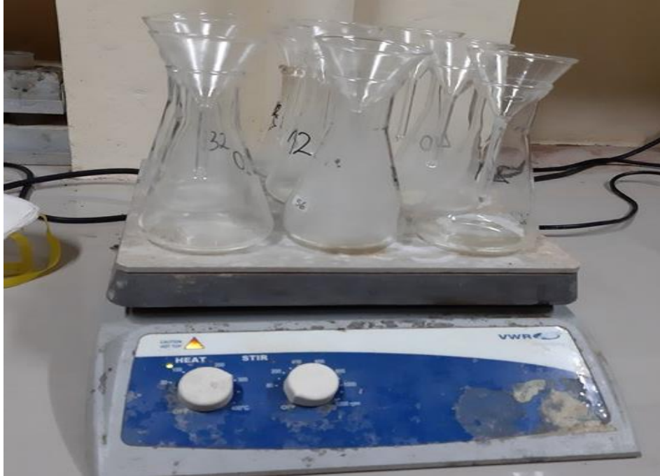
Figura 63. Digestion por ácido nítrico-perclórico para determinación de niveles de cadmio total.
