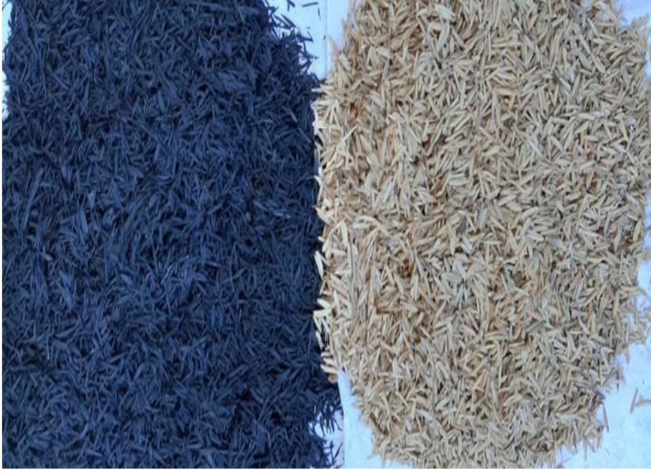
Figura 45. Biocarbón obtenido a partir de la biomasa de la cascarilla de O. sativa .
