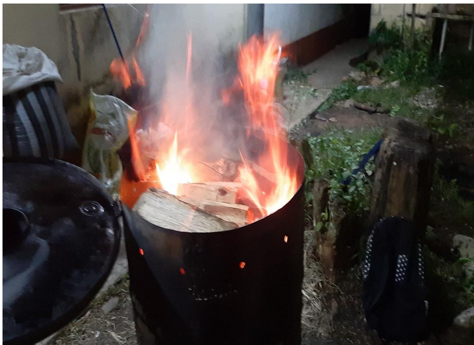
Figura 40. Inicio de la llama al interior de horno pirolítico utilizado en el estudio.
