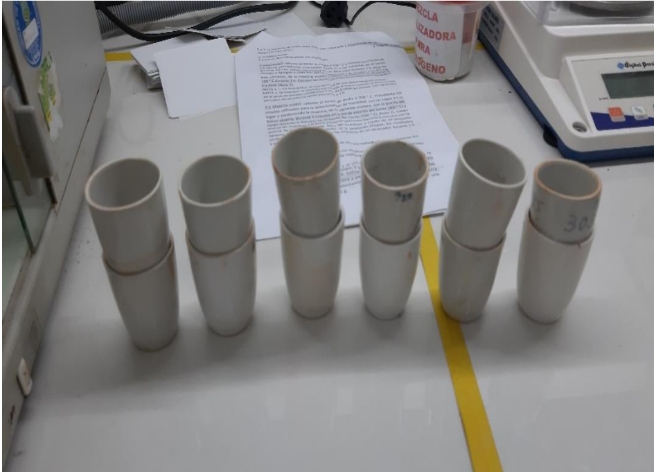
Figura 49. Determinación del contenido de humedad en muestras de biocarbón.
