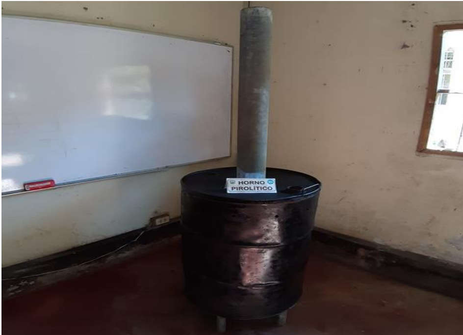
Figura 37. Horno pirolítico elaborado para la producción del biocarbón.
