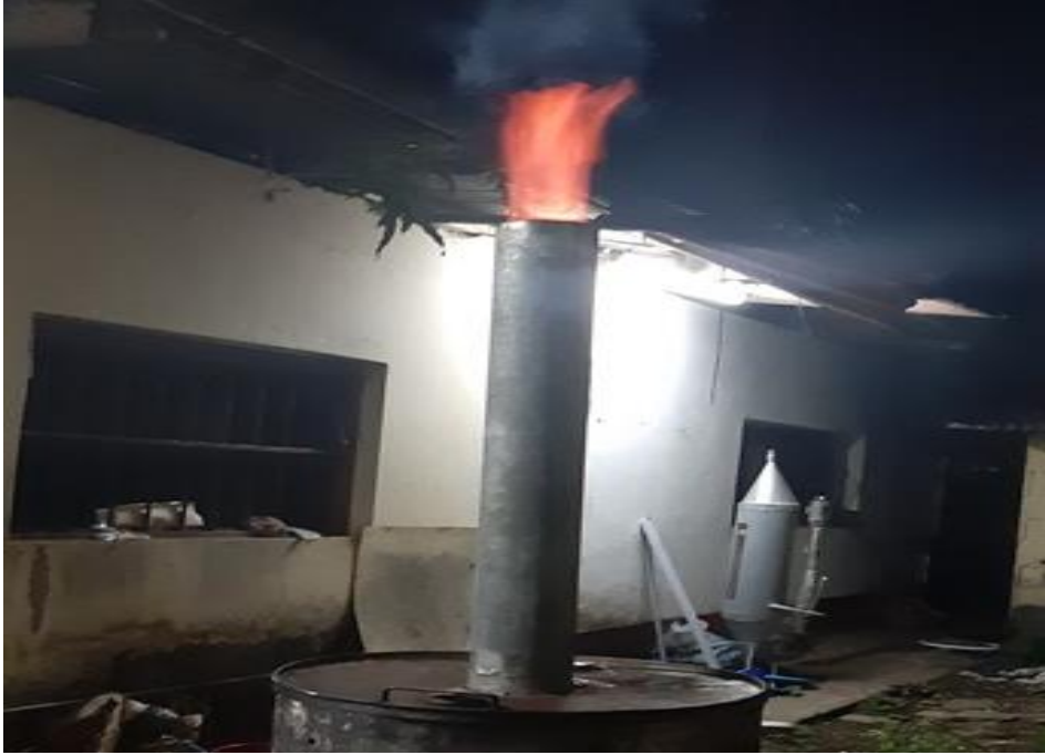
Figura 41. Cierre del horno pirólítico e inicio de la pirólisis lenta.
