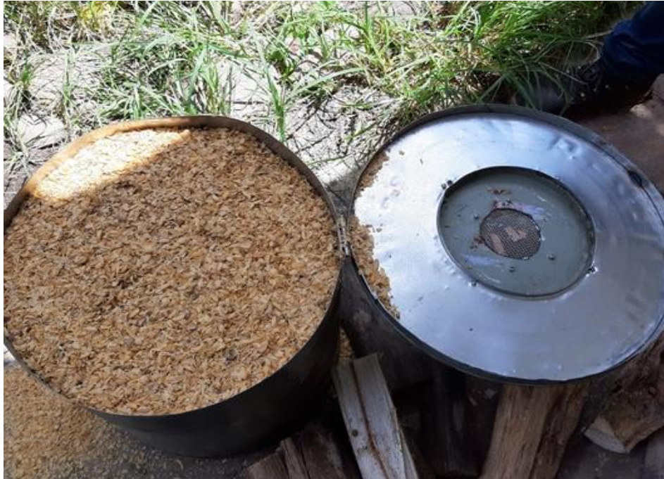
Figura 39. Colocación de la cascarilla del C. arabica en la cámara interna de horno pirolítico.
