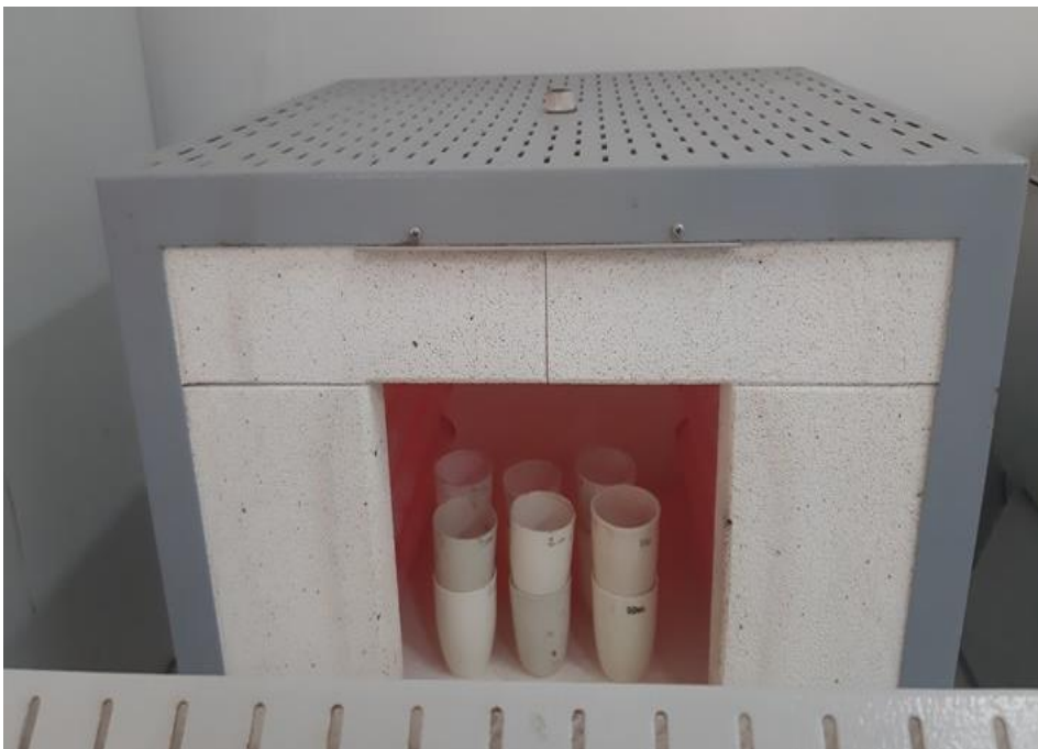
Figura 50. Muestras de biocarbón en el mufla para determinación del porcentaje de ceniza.
