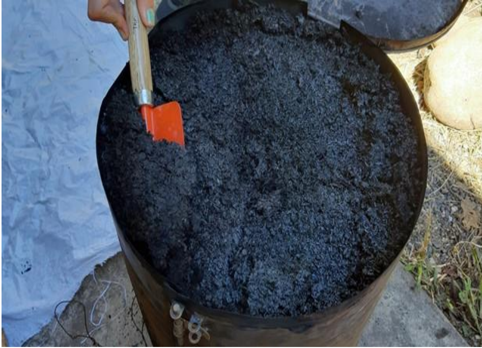
Figura 43. Biocarbón resultante del proceso de pirólisis por un tiempo de 12 horas.
