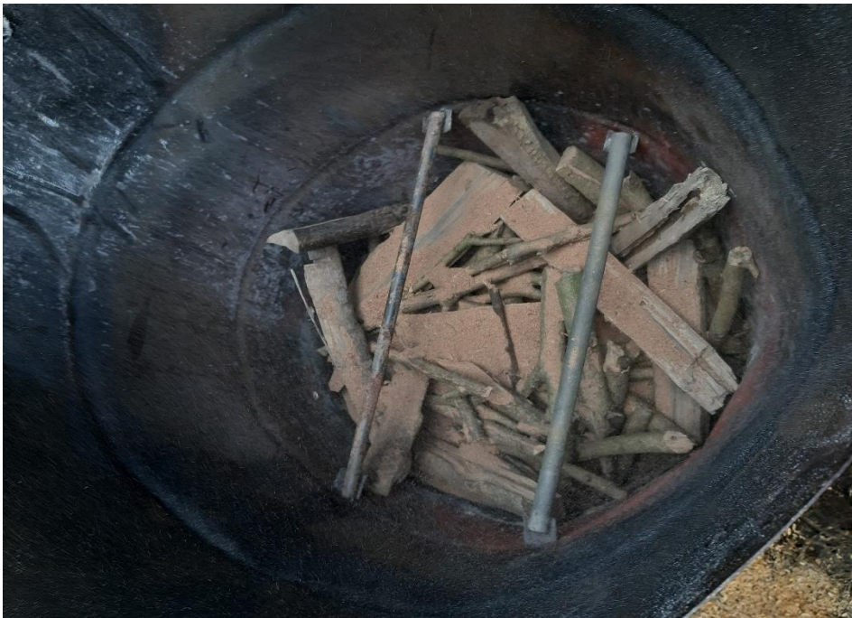
Figura 38. Acodicionamiento con leña y ramas al interior del horno pirolítico.
