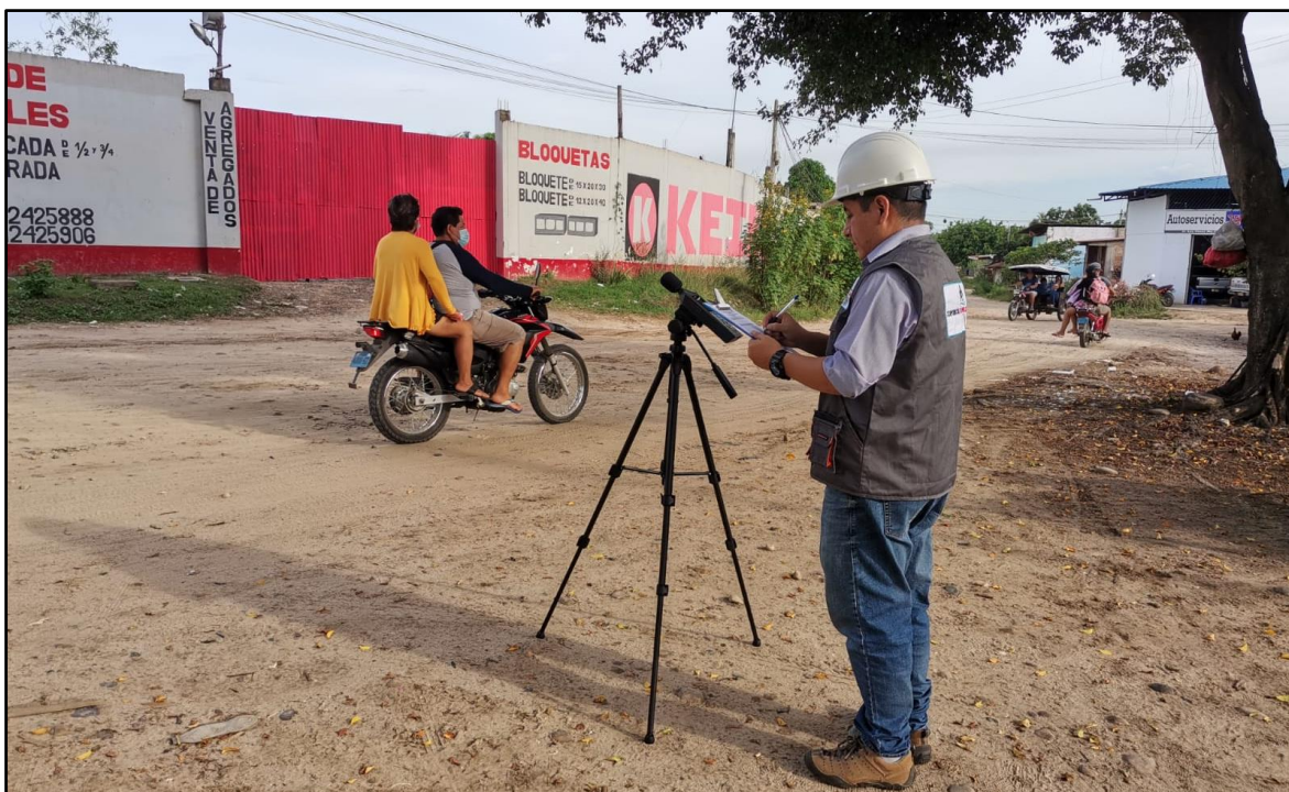
Monitoreo de ruido, horario diurno – Av. V. de Evitamiento/Jr. 10 de agosto – Sector Atumpampa.
