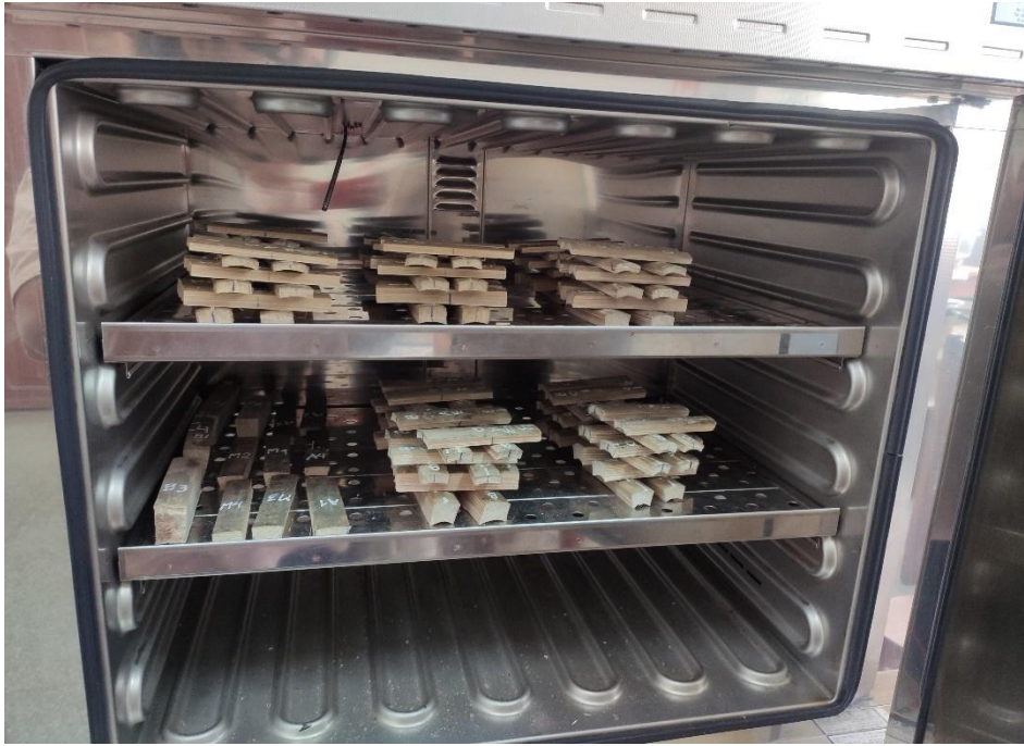
Figura 28. Probetas sometidas a la estufa
