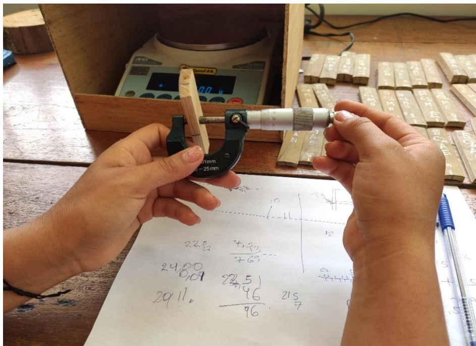
Figura 27. Medición en la sección tangencial y radial de las probetas obtenidas
