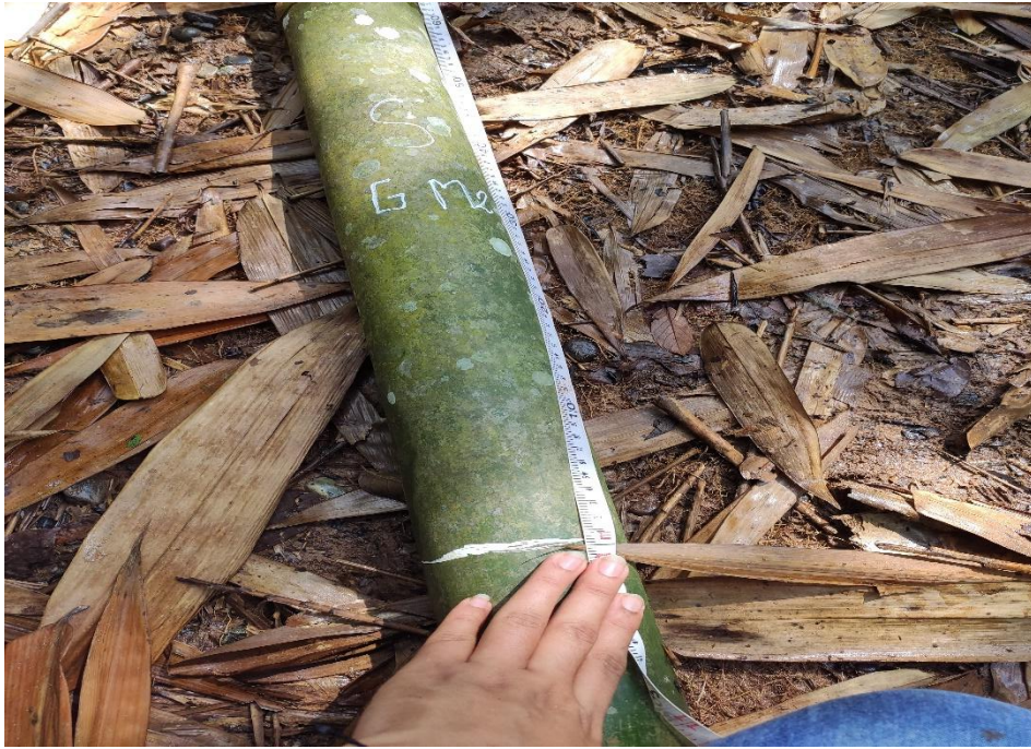
Figura 20. Medición de la longitud de internudos
