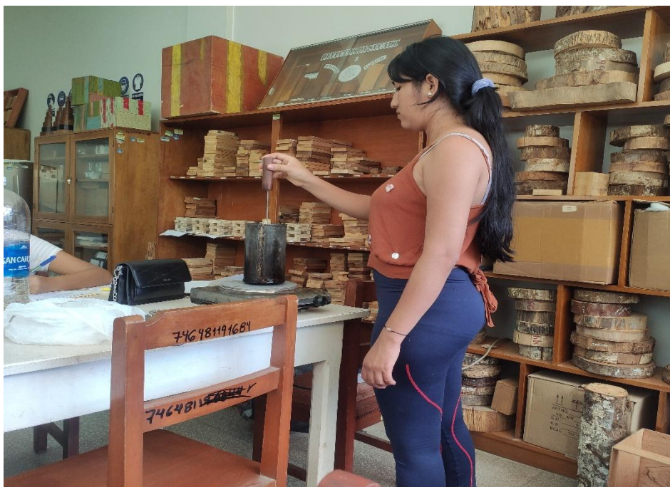
Figura 29. Parafinado de probetas
