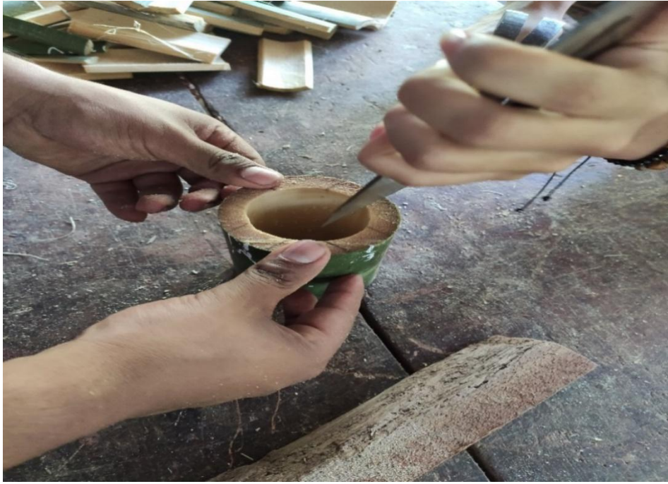
Figura 22. Obtención de probetas para ensayos físicos
