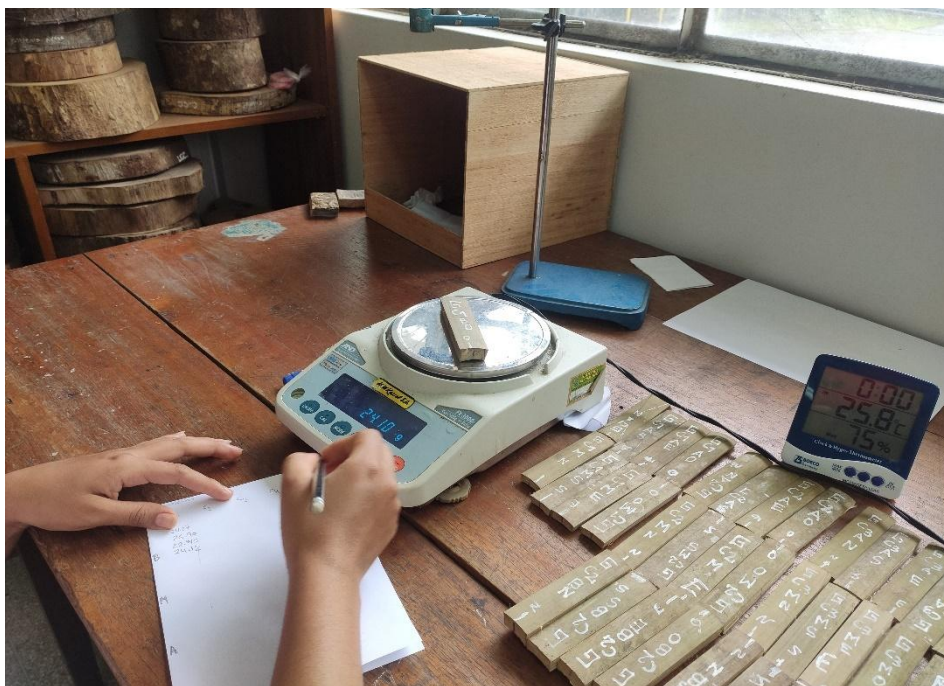
Figura 25. Registro de pesos de las probetas
