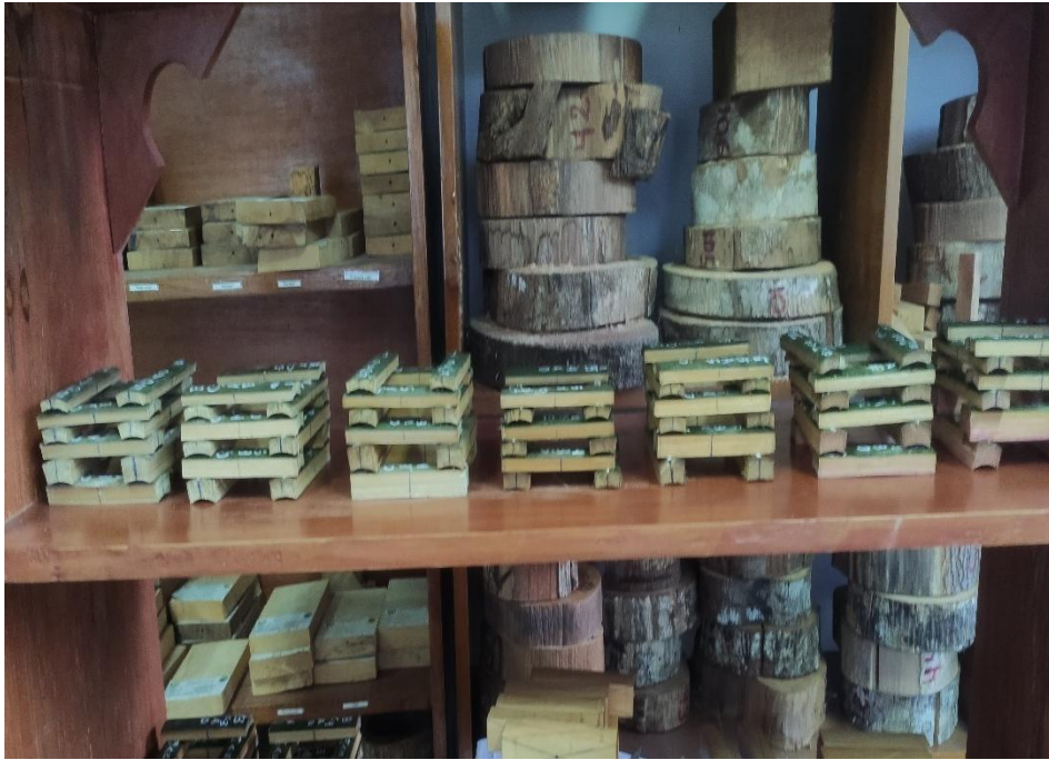
Figura 24. Acondicionamiento de las probetas
