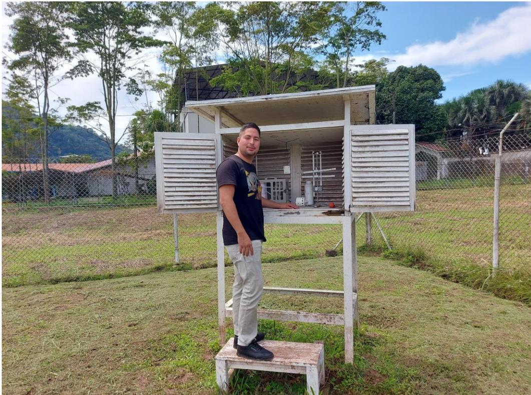
**Figura 10.** Limpieza de la garita termopluviométrica.
