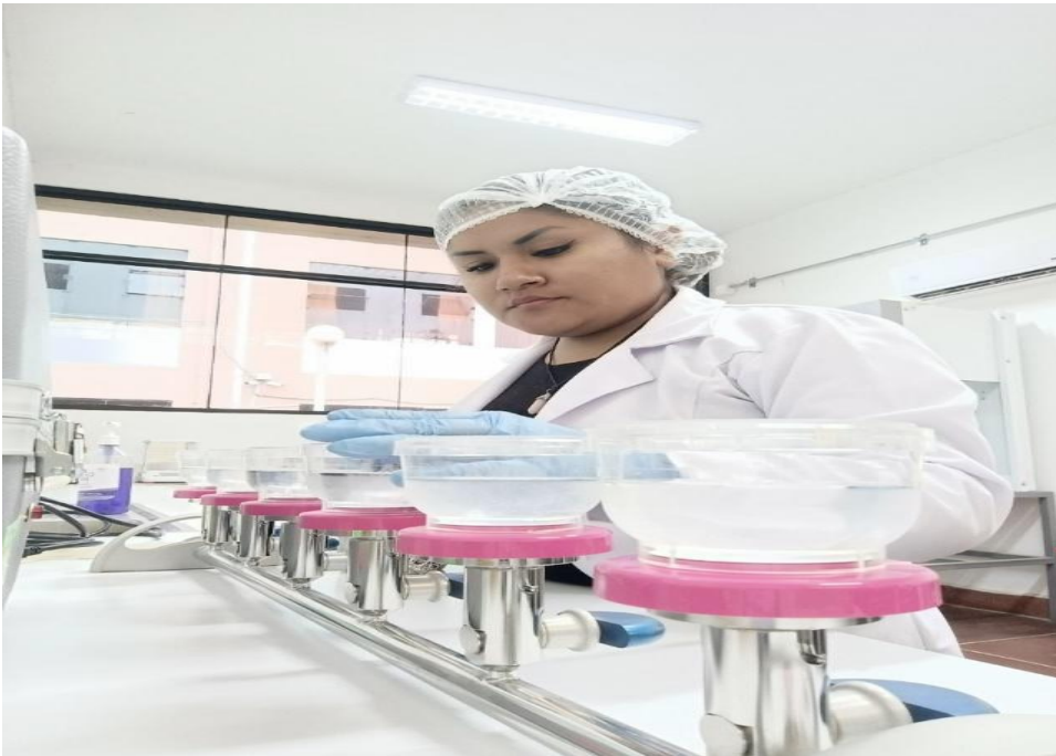
Figura 46. Sistema de filtración de membranas
