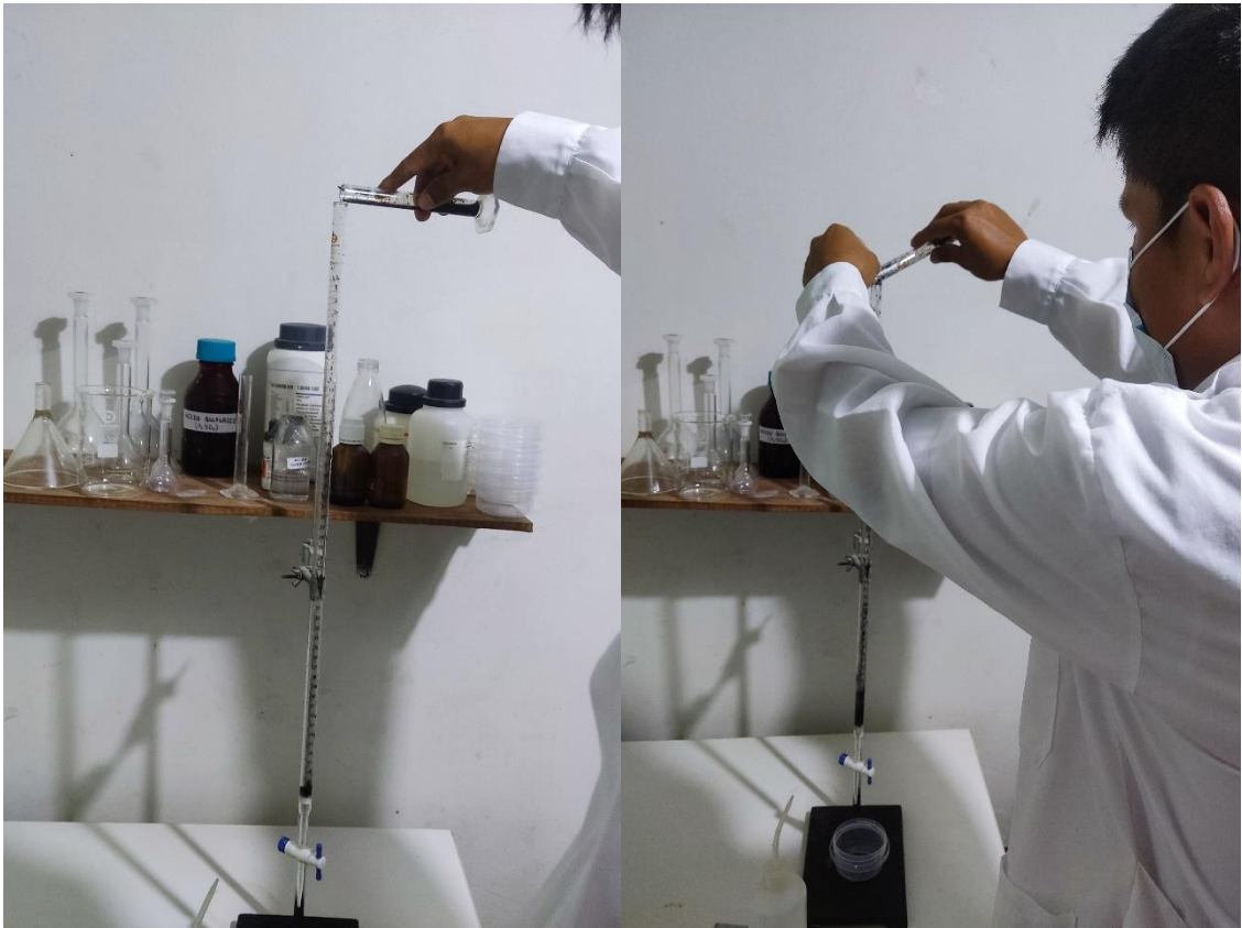
Figura 20. Llenado de bureta con el carbón vegetal
