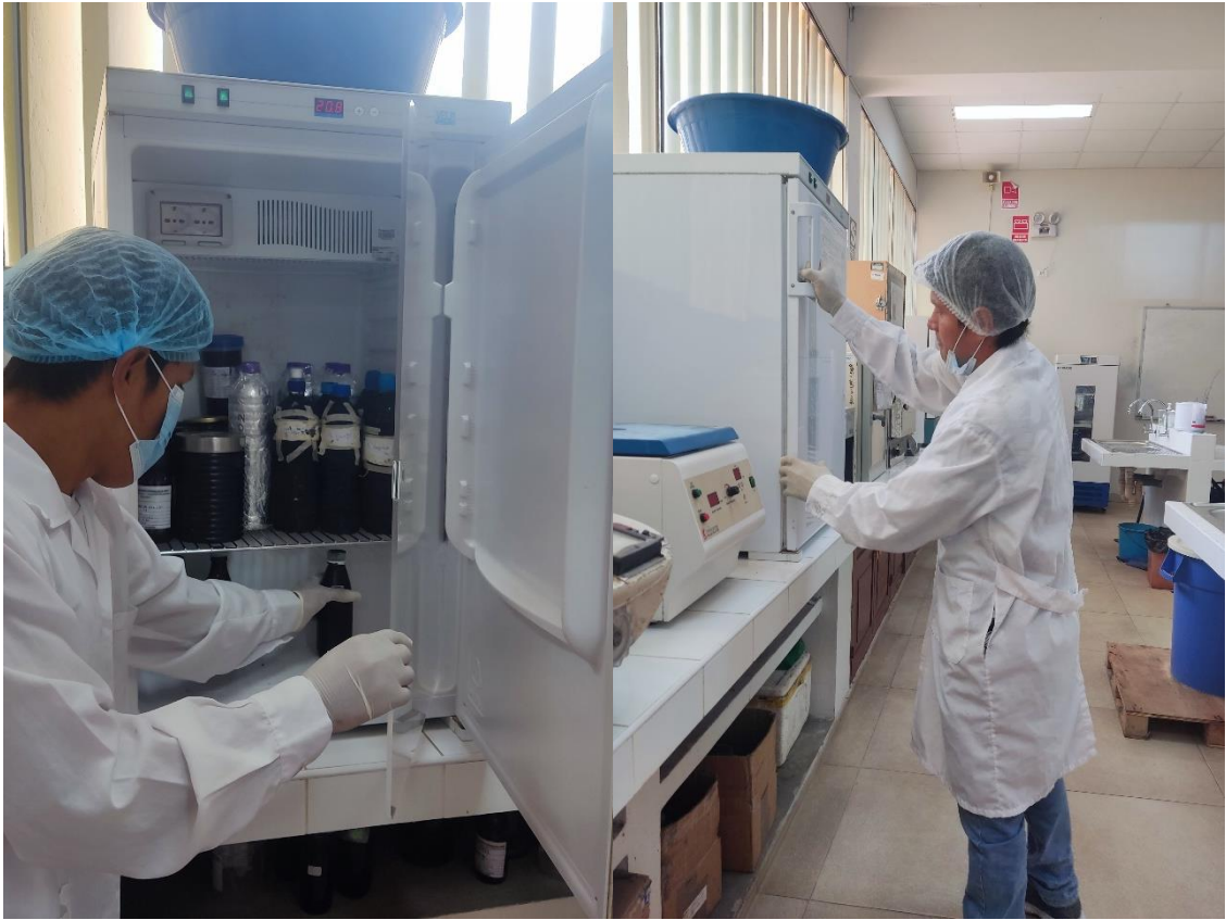
Figura 19. Incubación de muestras para análisis de DBO
