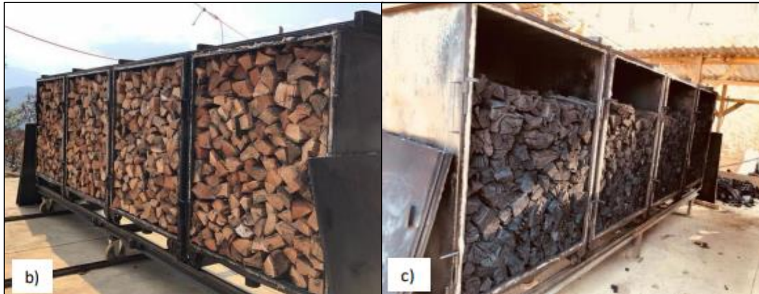
Figura 3. Pirólisis de la madera para producir carbón vegetal
