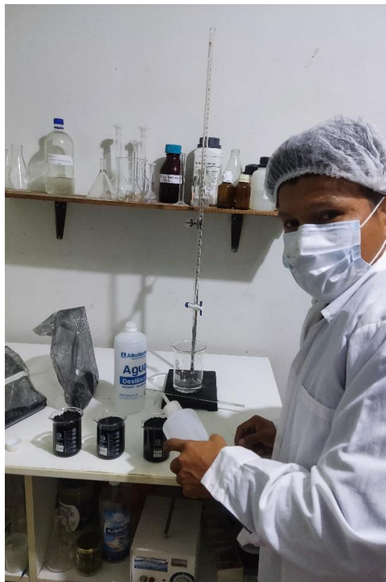
Figura 22. Aplicación de tratamiento de filtración de lixiviado.
