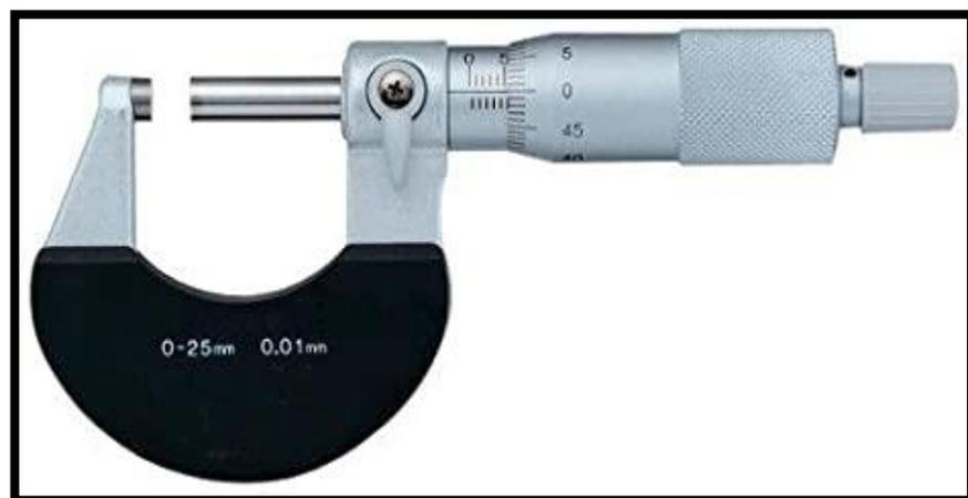
Figura 9. Imagen del micrómetro usado para para medir el espesor de cada bioplástico
