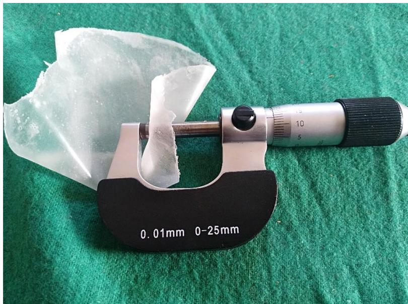
Figura 21. Micrómetro usado para determinar el espesor
