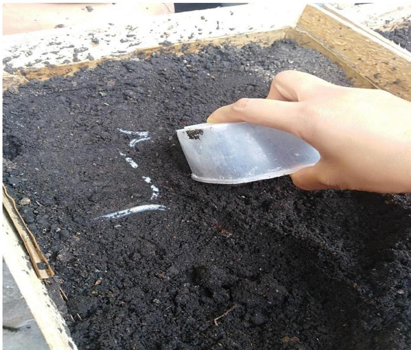
Figura 36. Enterramiento de las muestras en el compost
