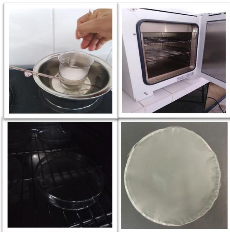
Figura 10. Elaboración del Bioplástico
