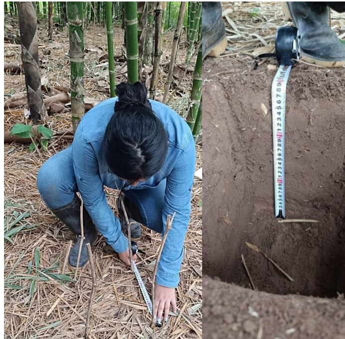
Figura 31. Medición del monolito (25 x 25 cm de ancho por 30 cm de profundidad).
