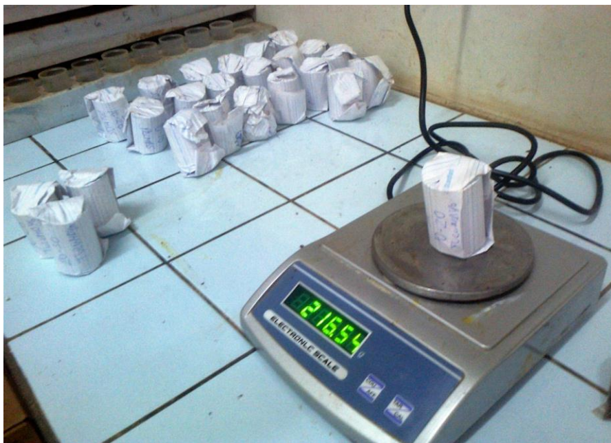
Figura 13. Cilindro con suelo para determinación de densidad aparente
