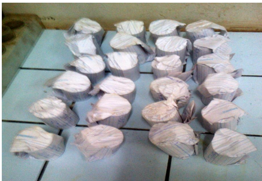
Figura 14. Pesado de cilindros con suelo después de secado en estufa.
