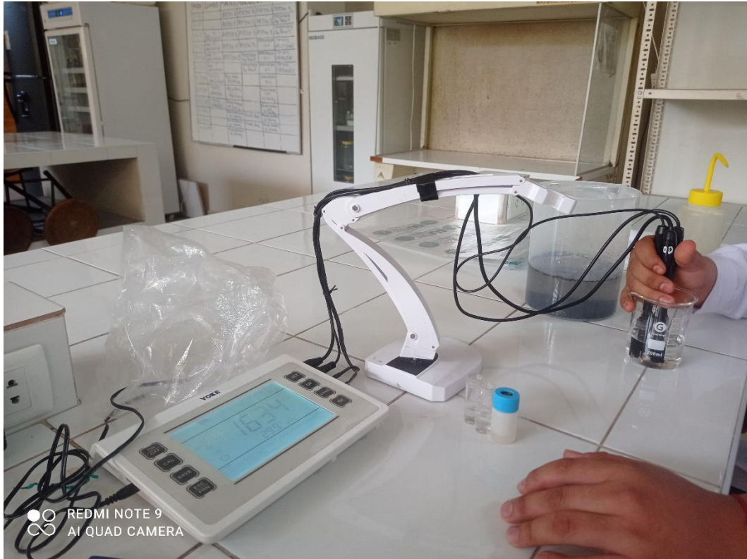
Figura 37. Medición de parámetros fisicoquímicos del filtrado
