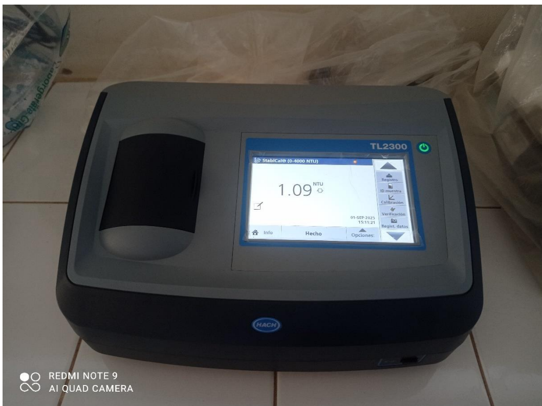
Figura 38. Medición de turbiedad de las muestras de aguas filtradas
