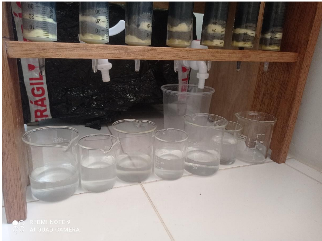
Figura 35. Proceso de filtración de aguas mieles
