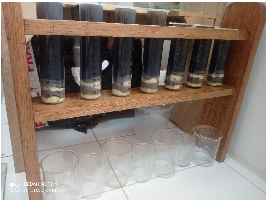
Figura 34. Acondicionamiento del filtro de lecho fijo
