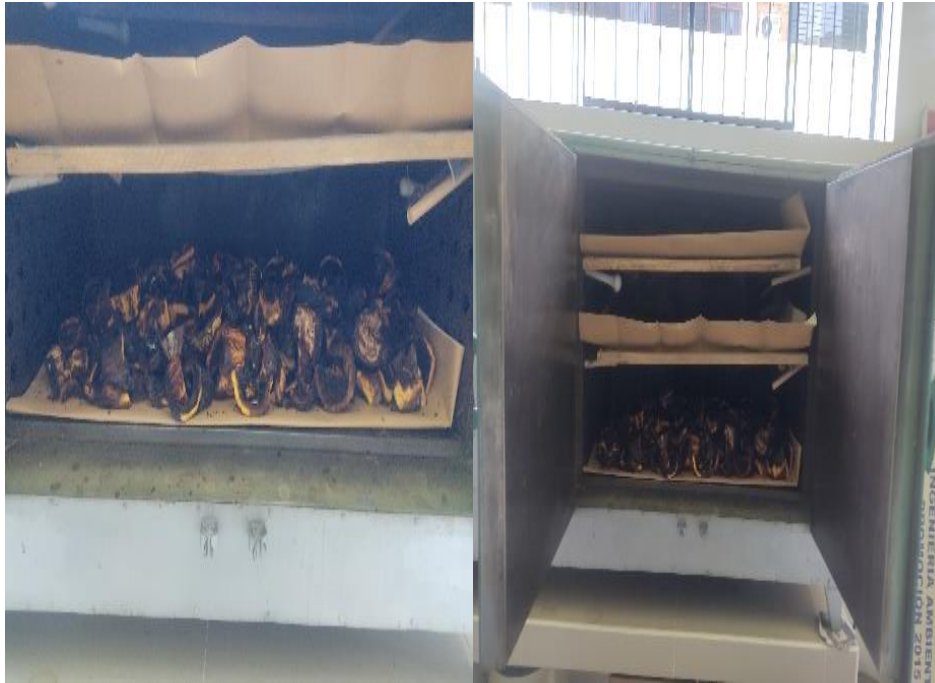
Figura 51. Secado de biomasa para producción de carbón vegetal
