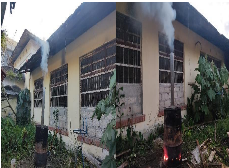
Figura 63. Verificación de emisiones de humo para el control de producción de carbón vegetal – Perdida de agua
