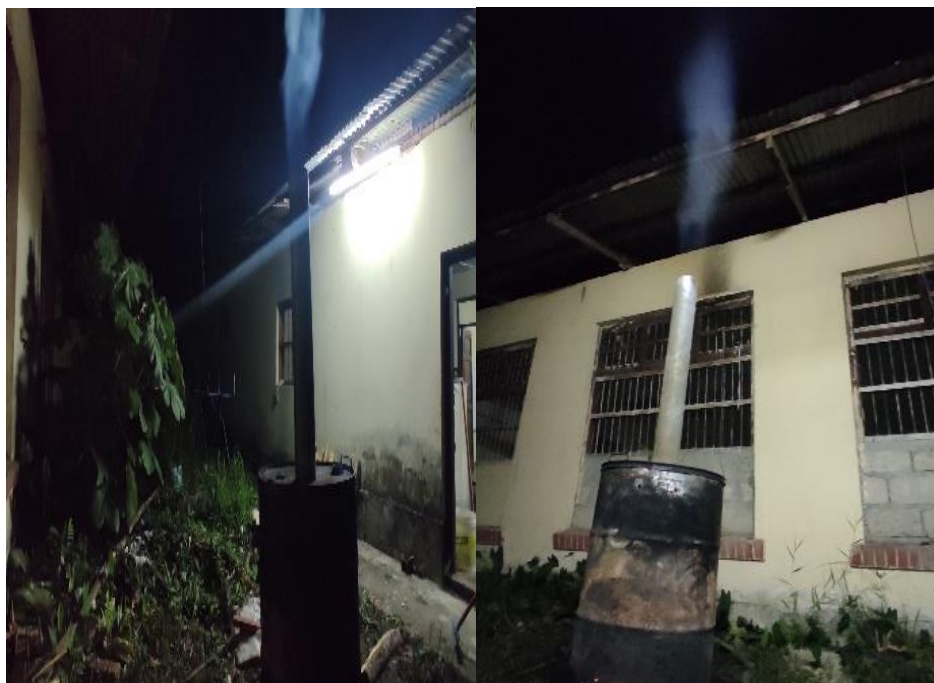
Figura 64. Verificación de emisiones de humo para el control de producción de carbón vegetal – Indicador fin de proceso
