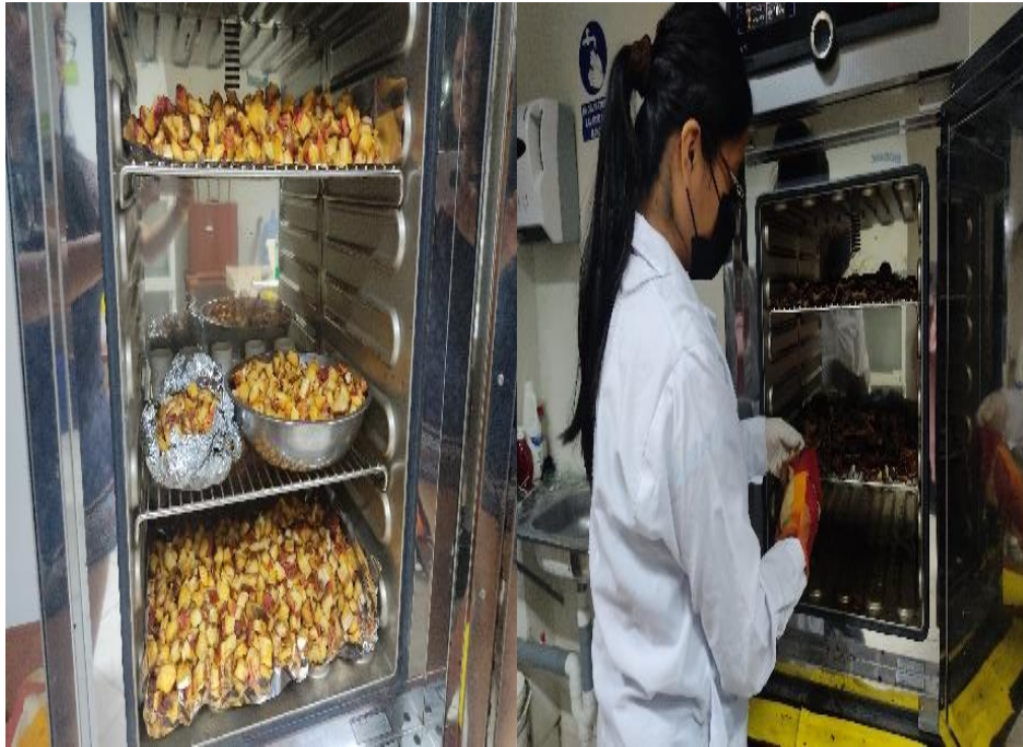
Figura 69. Secado de biomasa en estufa
