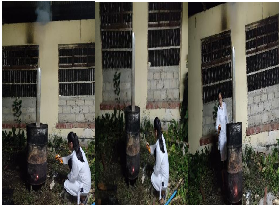
Figura 66. Medición de temperatura de producción de carbón vegetal
