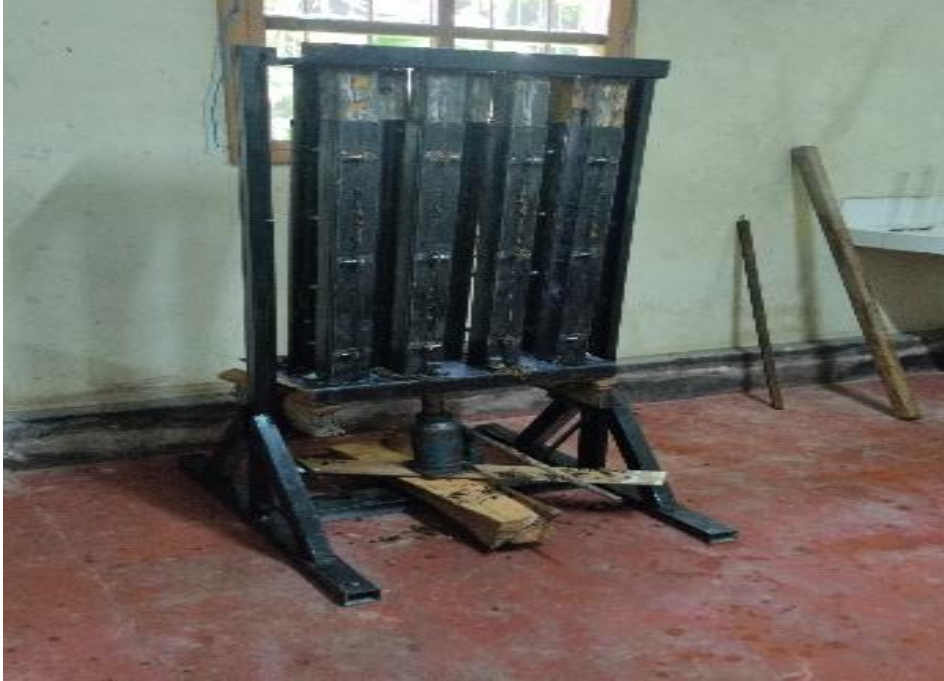
Figura 9. Maquina briquetadora de prensado
