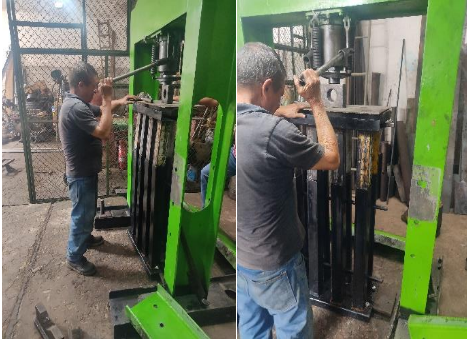
Figura 75. Compactación de 2 TN con maquina briquetadora
