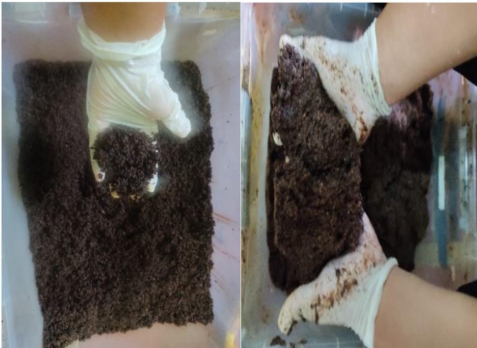
Figura 80. Mezcla de biomasa y aglutinantes
