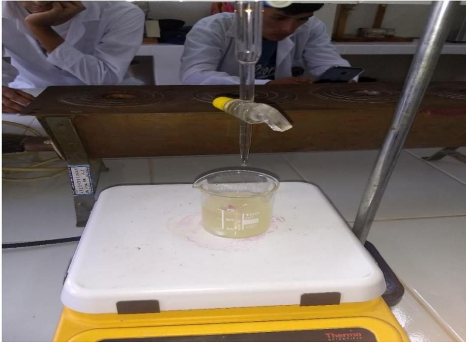
Figura 24. Determinación del índice de acidez por Titulación de NaOH 0.1 N.
