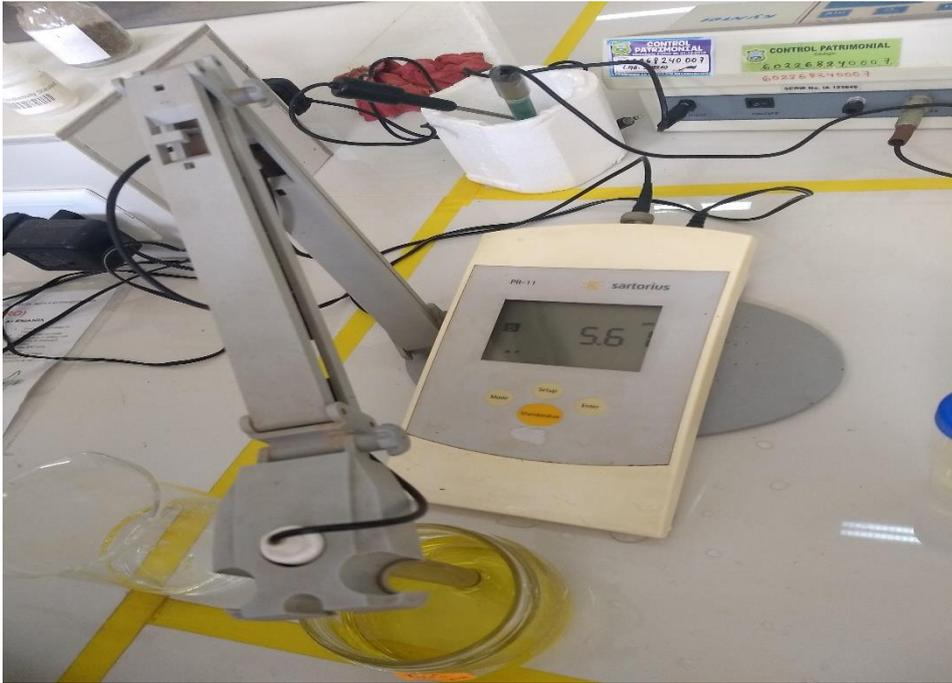
Figura 32. Pruebas de calidad de biodiesel (pH).
