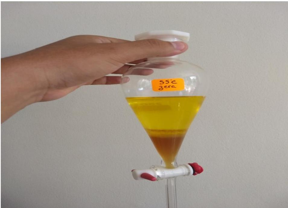
Figura 26. Obtención de biodiesel (parte superior) y glicerina (parte inferior).
