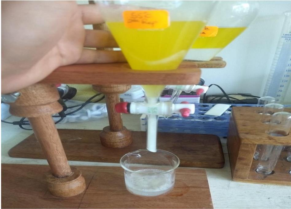
Figura 28. Separación de material residual del biodiesel por lavado.
