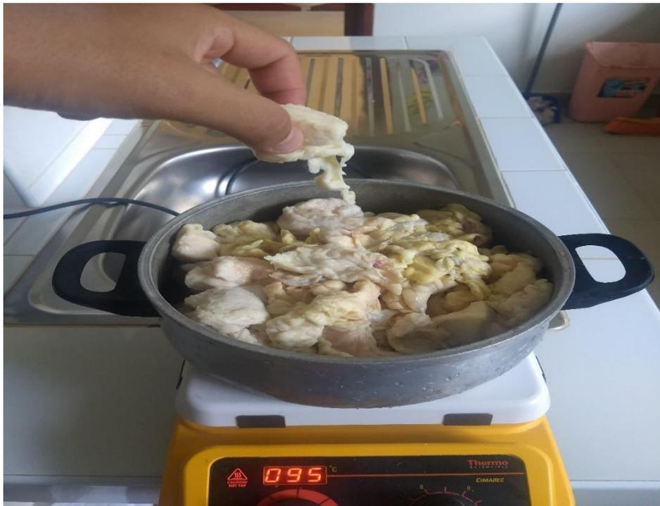
Figura 20. Calentamiento de materia prima para obtención de aceite.
