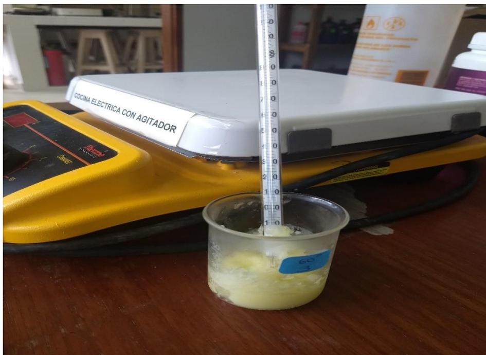
Figura 33. Pruebas de calidad de biodiesel (densidad).
