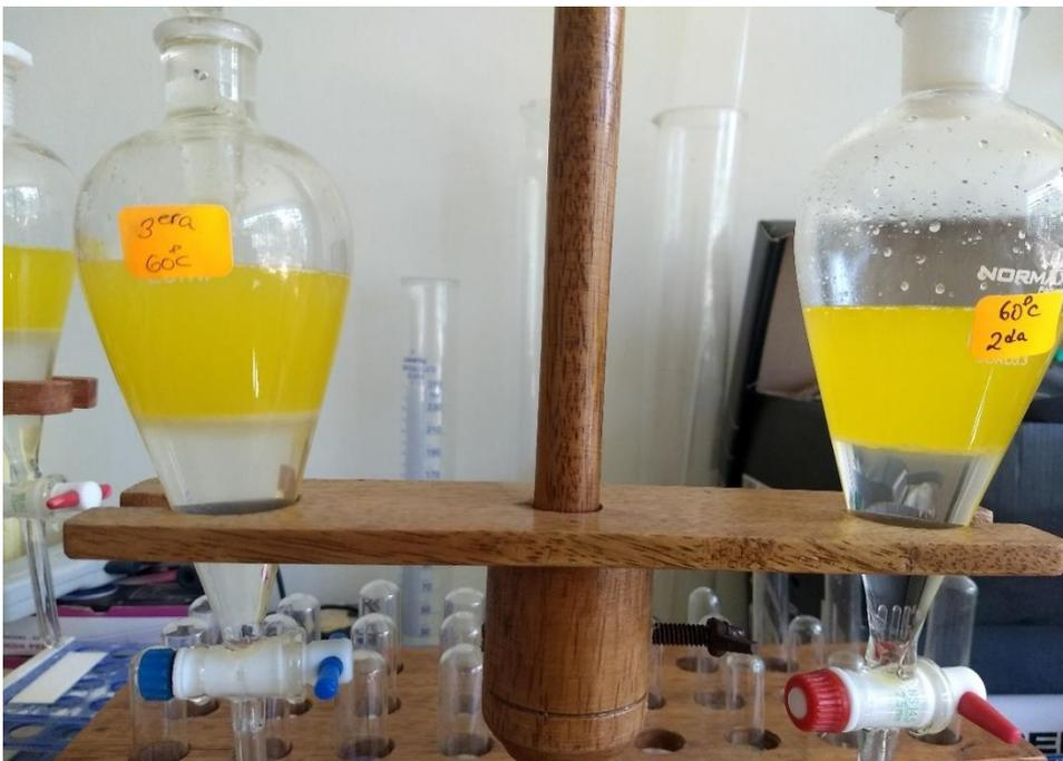
Figura 27. Lavado de biodiesel a 40% de agua destilada del volumen total.
