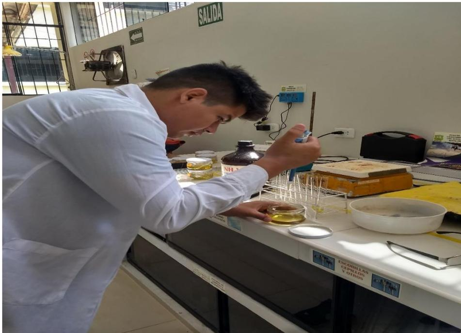
Figura 30. Pruebas de calidad de biodiesel (fosforo).
