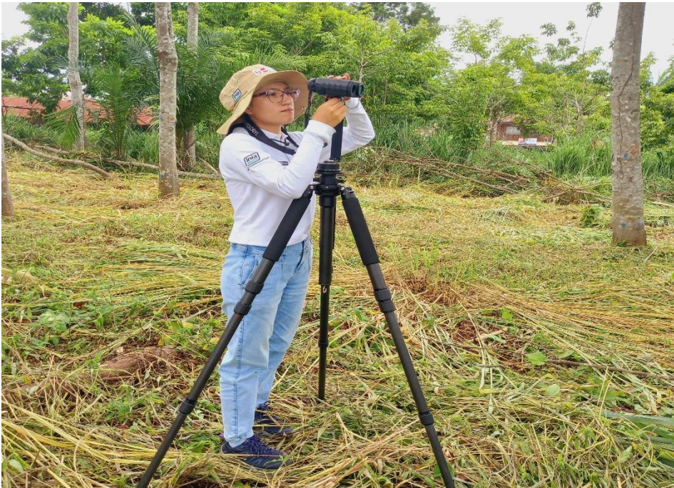
Figura 18. Colocación del Trupulse 360R al braket.
