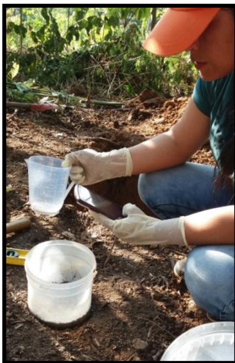
Figura 27. Determinación de la Infiltración
