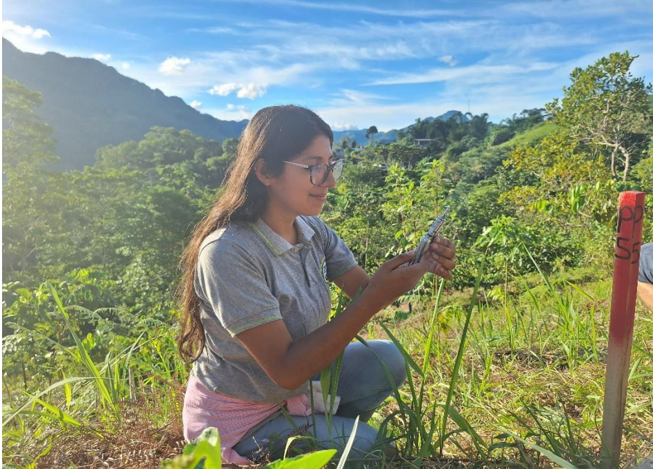
Figura 27. Medición de la compactación del suelo con penetrómetro de bolsillo ( \text{kg}/\text{cm}^2 ).
