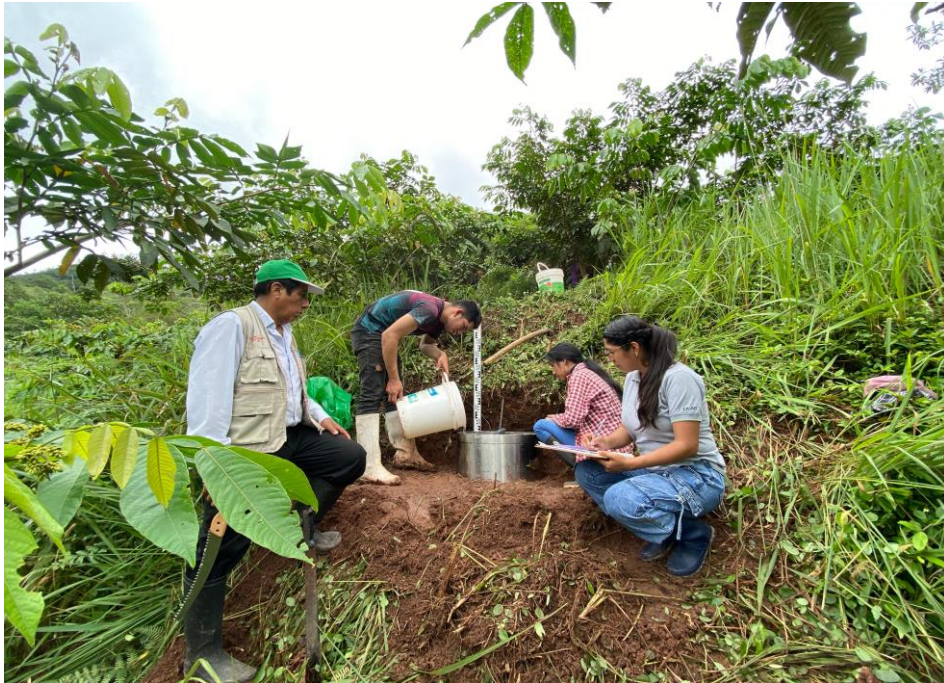
Figura 31. Evaluación de la infiltración del agua en la plantación de I. edulis en el año 2025.
