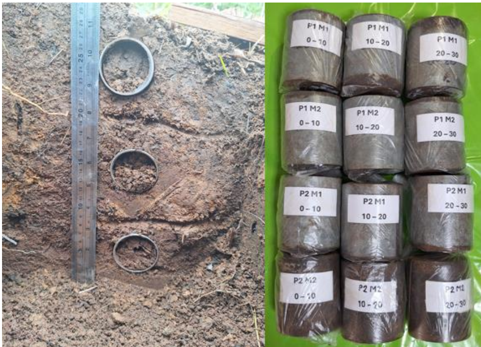
Figura 24. Muestreo de los suelos en tres profundidades empleando cilindros metálicos para determinar la densidad aparente.
