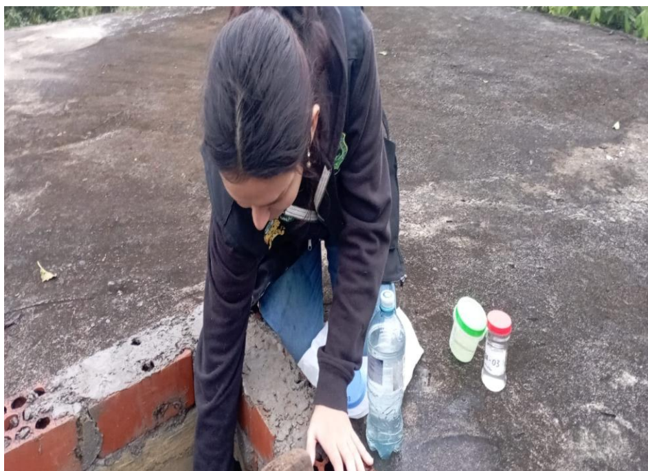
Figura 23. Recolección de muestras de agua del reservorio Supte Alto
