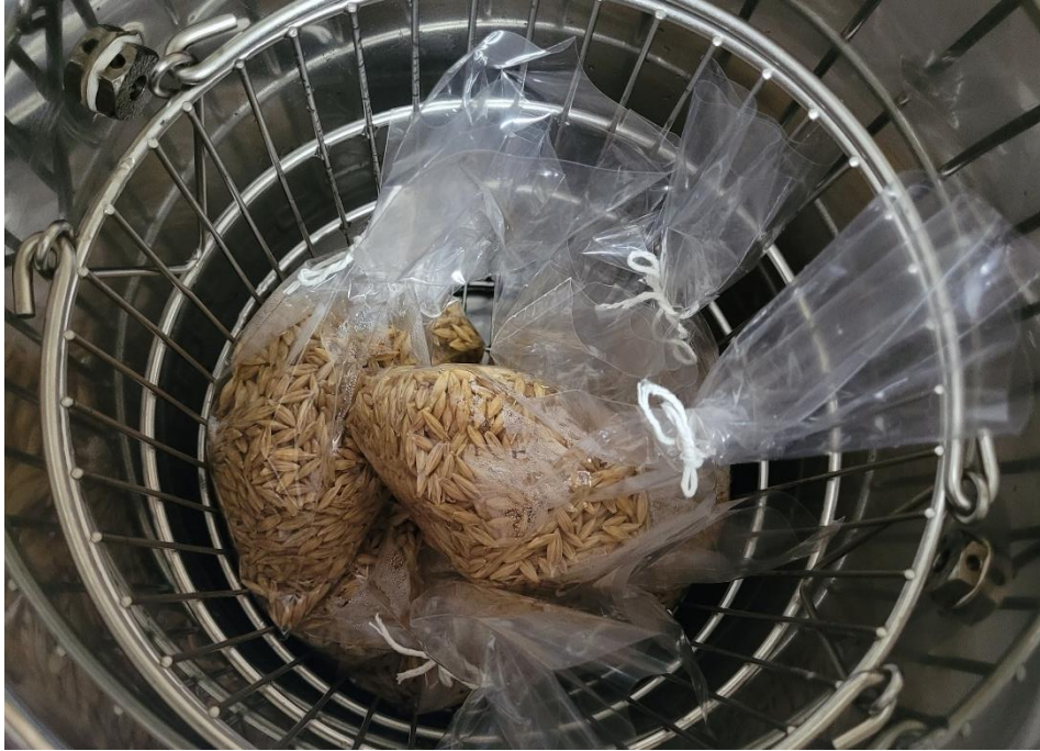
Figura 27. Esterilización de semillas en autoclave.
