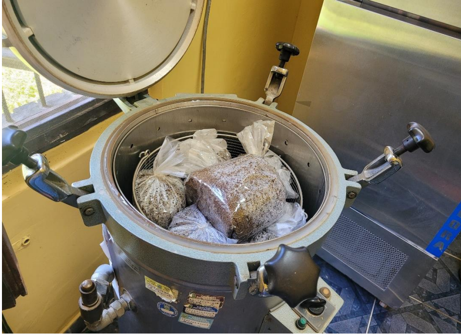
Figura 31. Esterilización de sustrato en autoclave.
