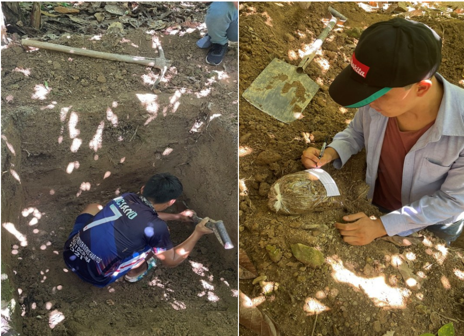
Figura 18. Excavación de calicatas y extracción de muestras de suelos
