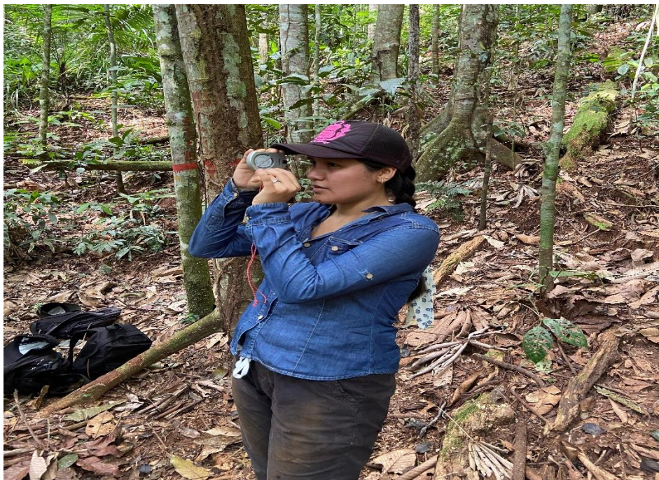
Figura 19. Medición con el clinómetro para determinar la altura total.
