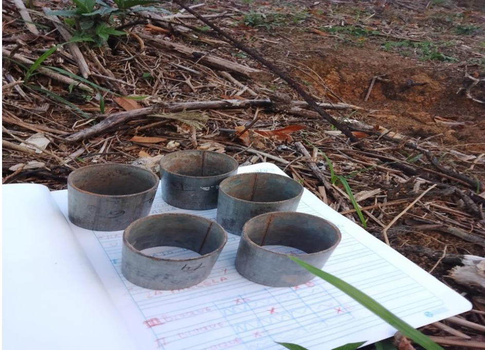
Figura 29. Muestreo inicial de suelo en investigación con método del cilindro (Da).
