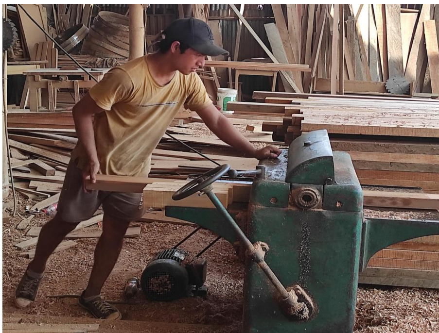
Figura 45. Cepillado de listones de madera.
