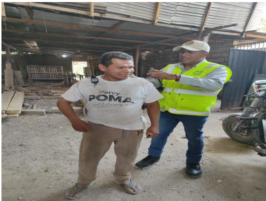
Figura 49. Monitoreo de ruido ocupacional con el dosímetro.
