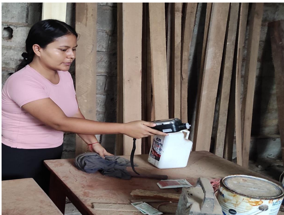
Figura 50. Monitoreo de compuestos orgánicos volátiles (COVs) con el equipo monitor MultiRAE Lite.
