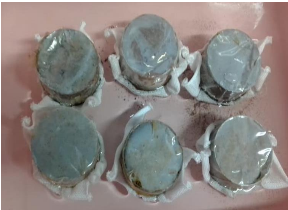
Figura 31. Muestras de suelo en anillo remojado
