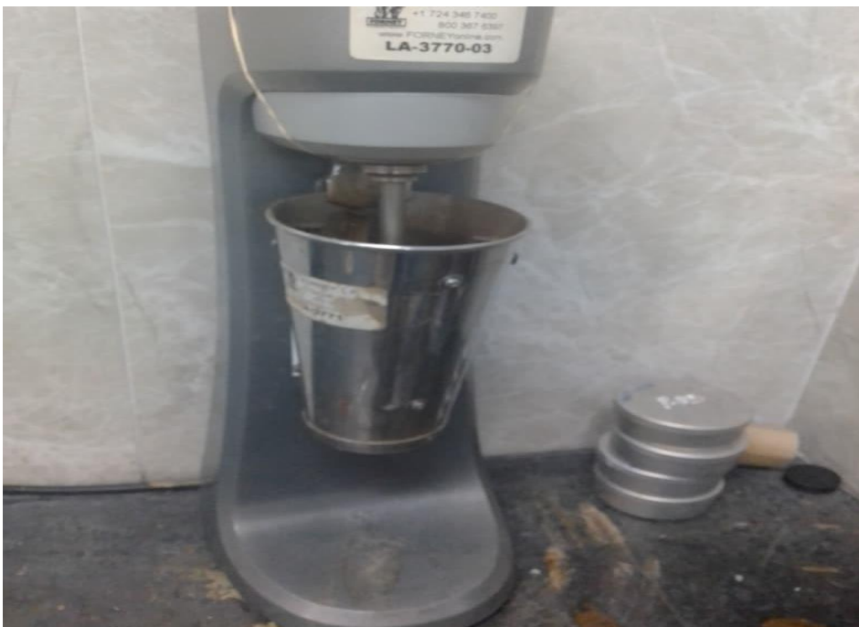
Figura 27. Agitador mecánico de suelos.
