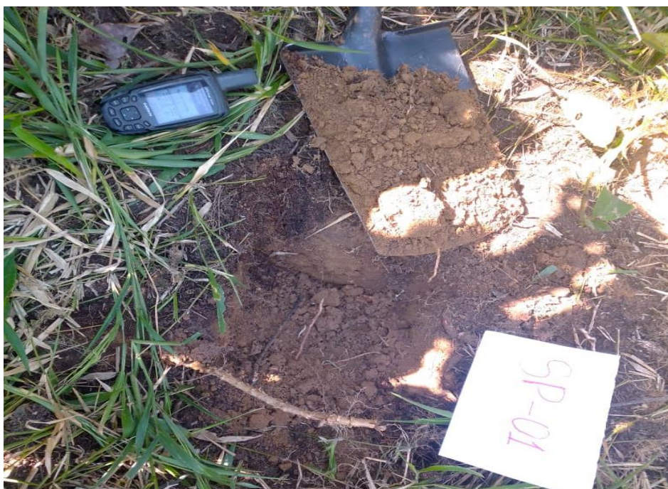
Figura 23. Muestreo del suelo y toma de las coordenadas
