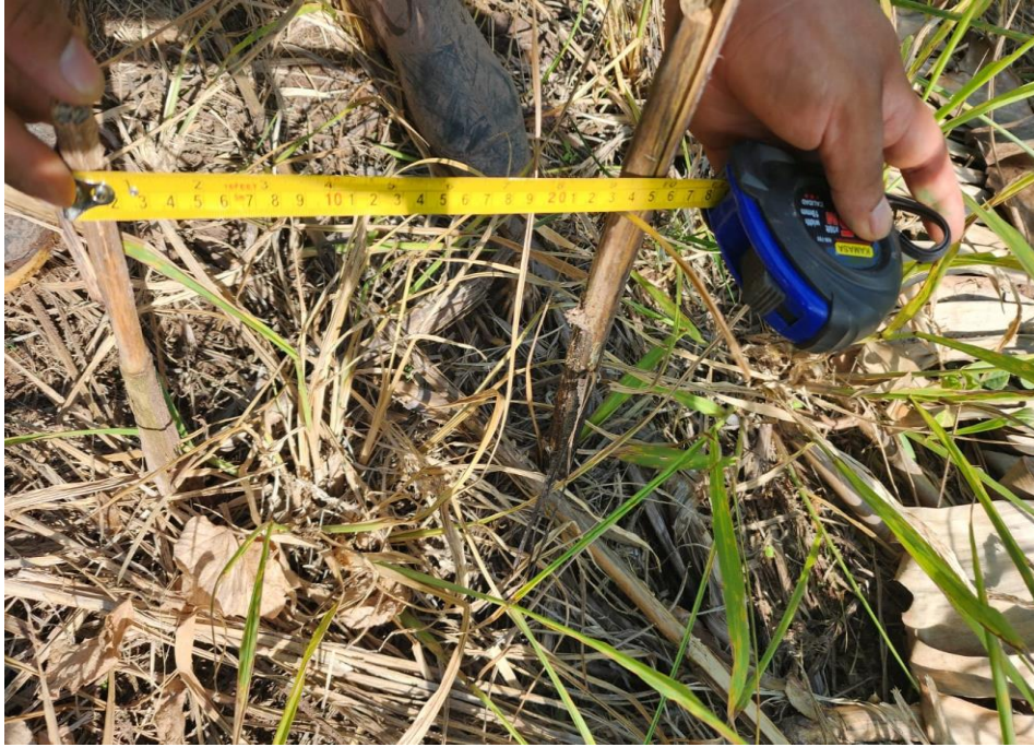
Figura 20. Dimensiones de 25 cm ancho x 25 cm largo y 30 cm de profundidad del monolito en el sistema platanal.
