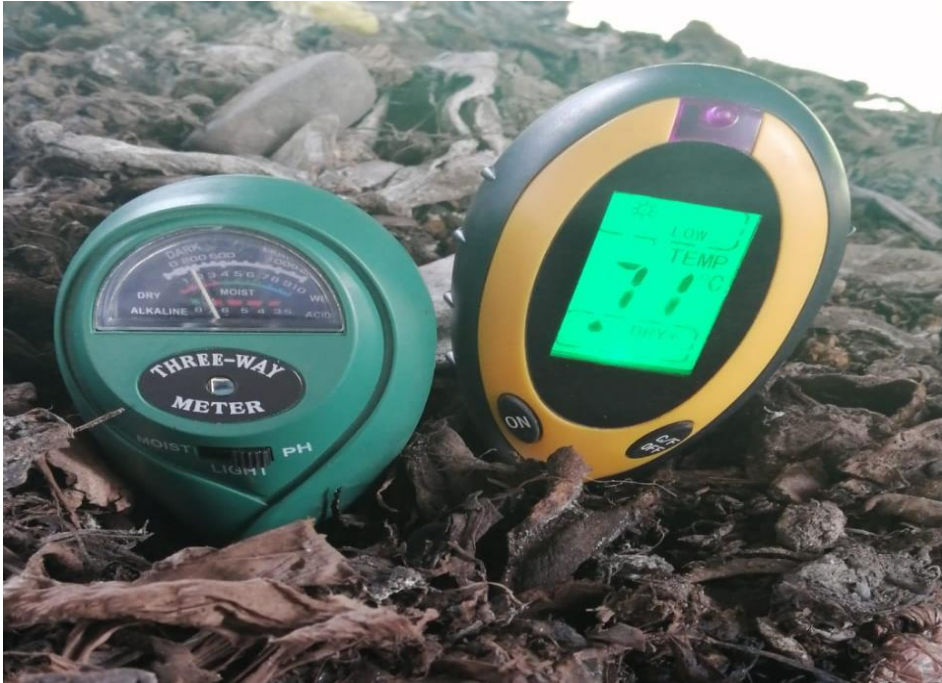
Figura 6. Equipos de medición del pH y T° durante el proceso de compostaje
