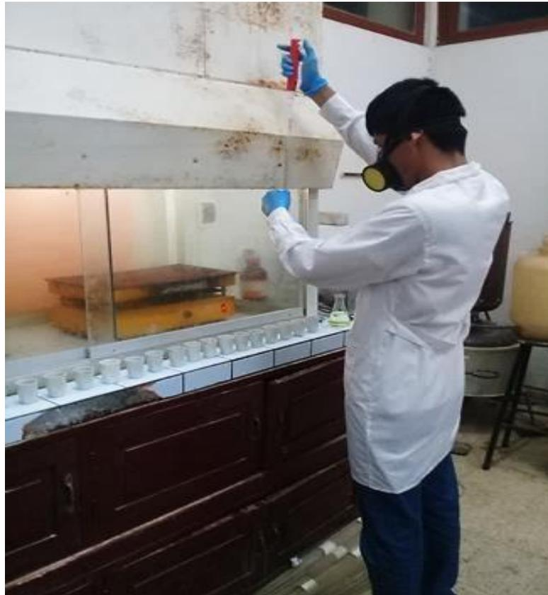
**Figura 36.** Agregando ácido clorhídrico a las muestras de tejido (hojas) de plántones de cacao.
