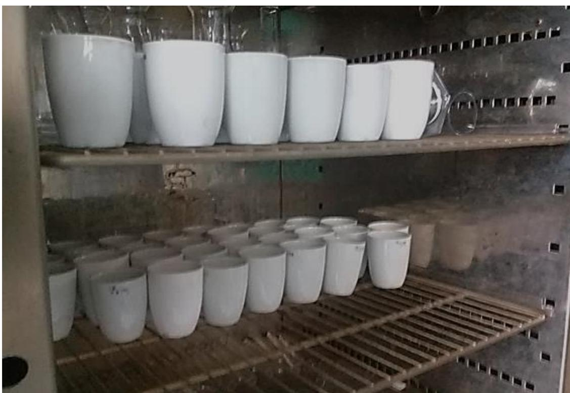
**Figura 35.** Muestras de hojas de plántones de cacao en crisoles en la mufla.
