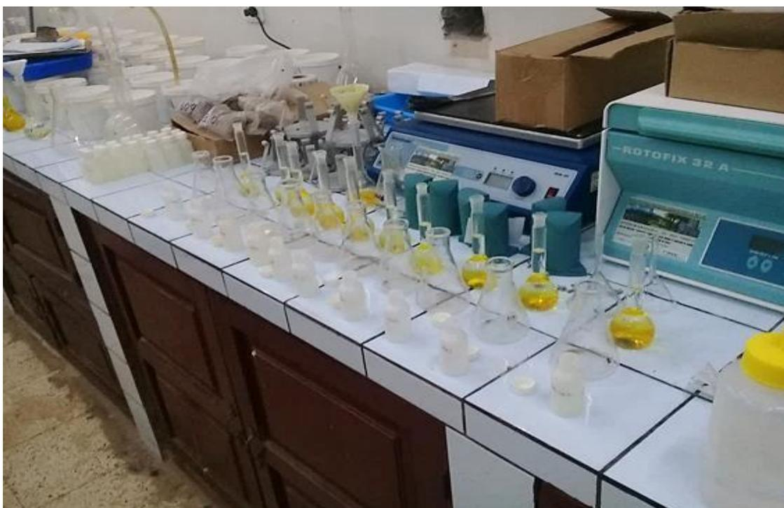
**Figura 34.** Filtrando las muestras de suelo para determinar Cd total en el suelo.
