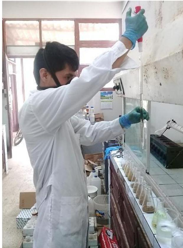
**Figura 32.** Agregando ácido nítrico a las muestras para la determinar Cd total en el suelo.
