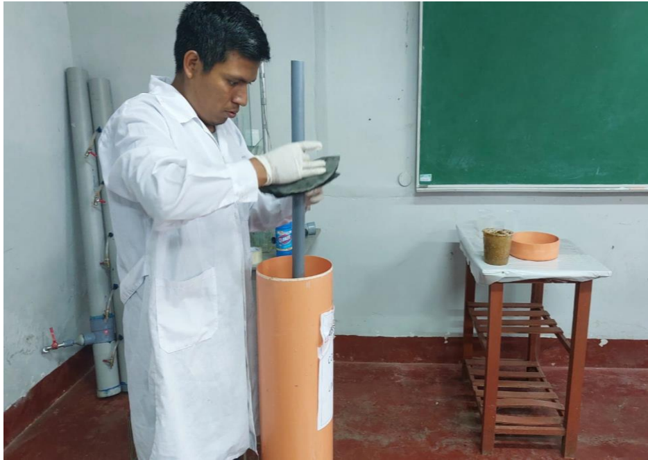
Figura 13. Prueba de cerrado del lisímetro
