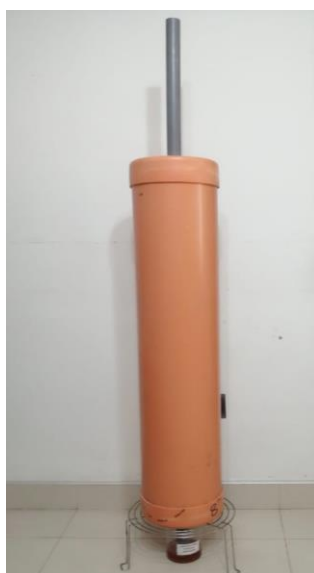
Figura 6. Lisímetro construido para la generación de lixiviados
