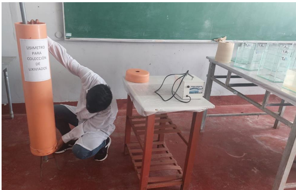
Figura 10. Ensamblaje de las partes del lisímetro para la instalación del sistema experimental,
