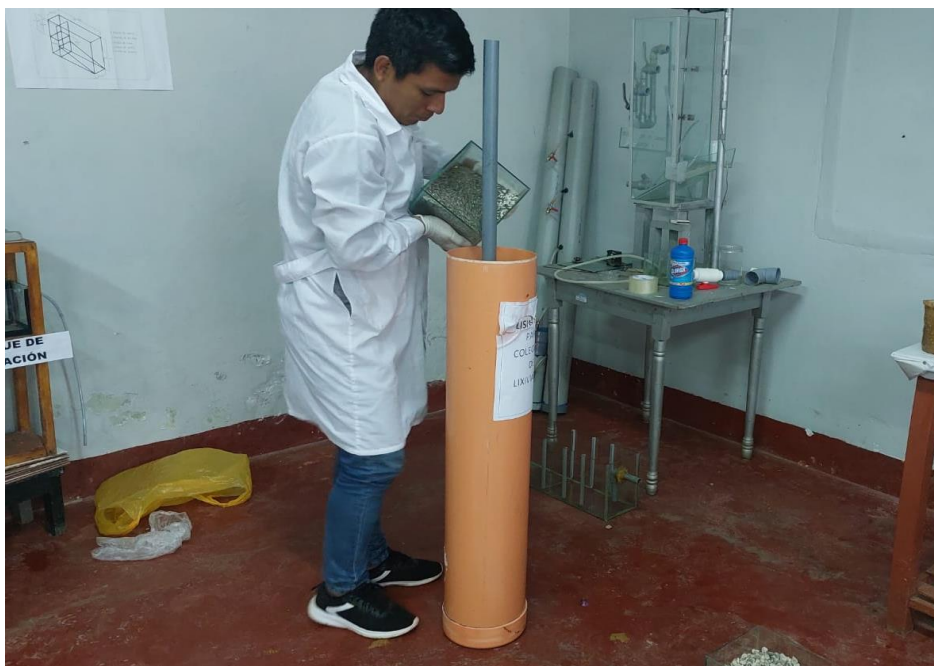
Figura 14. Vaciado de la grava para la base del lisímetro
