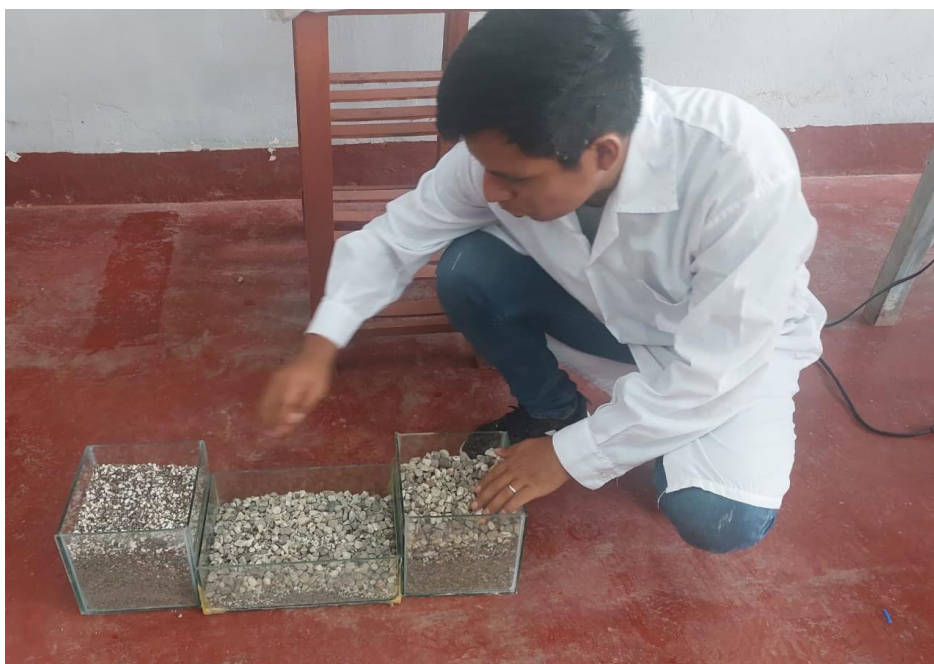
Figura 12. Acondicionamiento de la grava para implementación en la base del interior del lisímetro.
