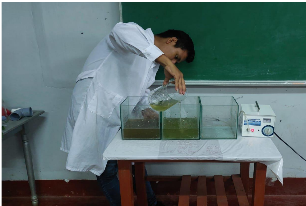
Figura 16. Carga de los lixiviados en las cámaras de ozonización
