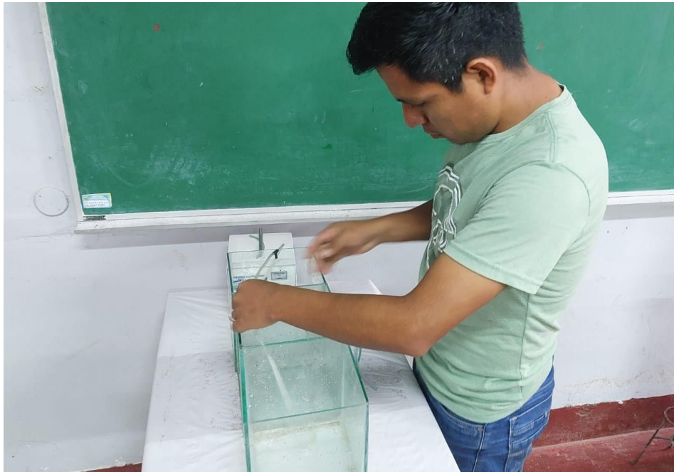
Figura 9. Preparación de las cubas de vidrio para la cámara de ozonización
