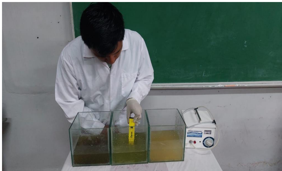
Figura 17. Medición del pH de los lixiviados en la cámara de ozonización.
