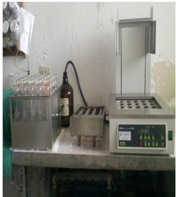
Figura 22. Determinación de la materia orgánica y del nitrógeno total (digestión).
