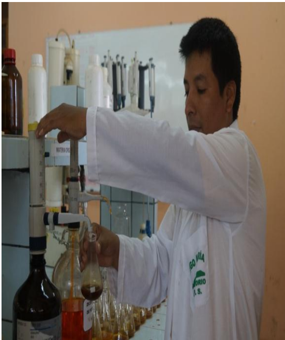
Figura 22. Determinación de la materia orgánica y del nitrógeno total (digestión).
