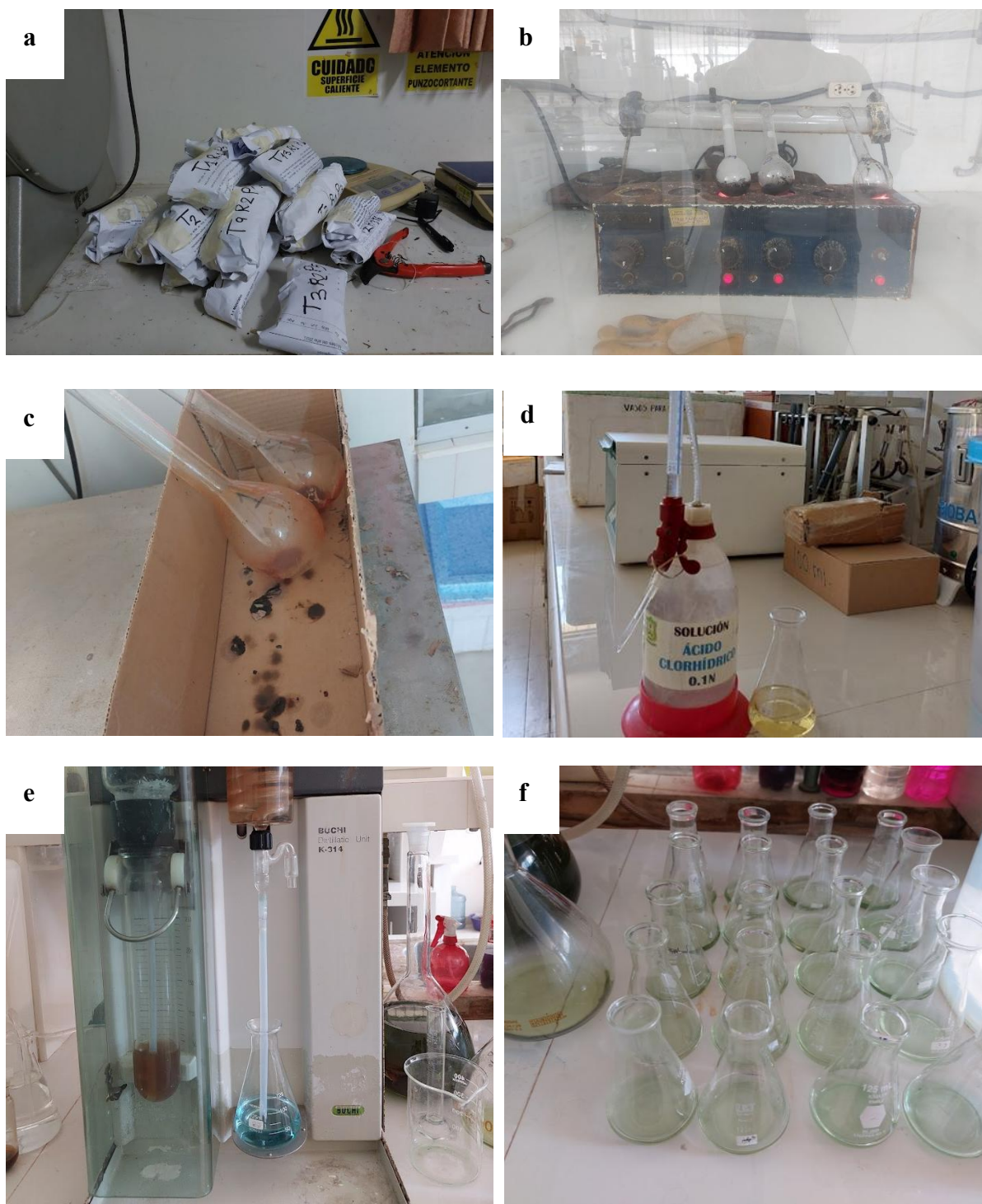
Figura 31. Determinación de macro y microelementos: a. Muestras salido de estufa para realizar el triturado, b. Cocinado de la ceniza con ácido Clorhídrico, c. enfriado después del cocinado la muestra en la estufa, d. preparado de Ácido Clorhídrico para tomar lectura según la reacción, e. Lectura según la reacción y f. Muestras para la lectura espectrofotómetro.
