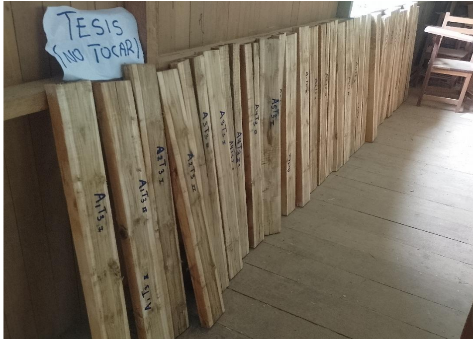
Figura 23. Secado al aire libre de madera.
