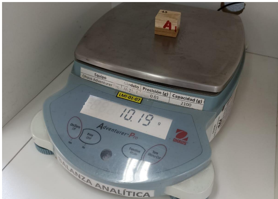
Figura 38. Pesado de los cubos de las probetas de flexión estática.
