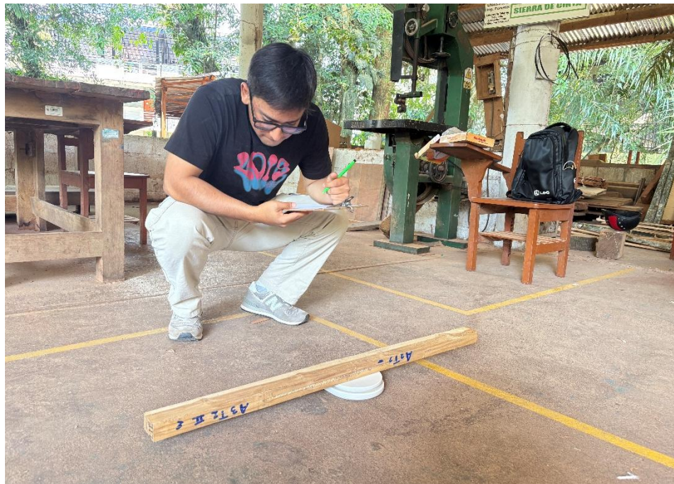
Figura 24. Seguimiento del secado mediante pesado.
