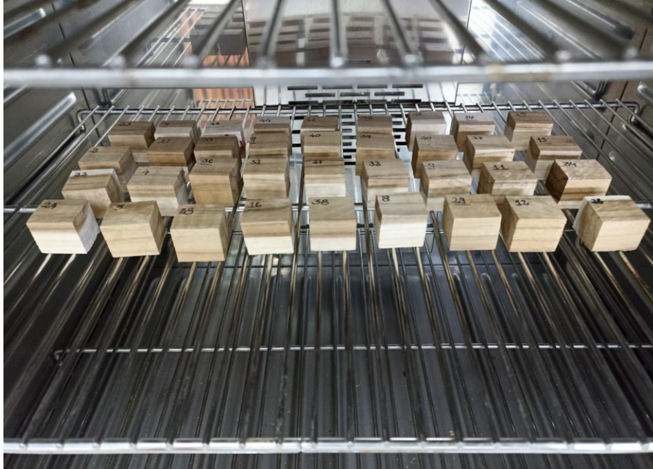
Figura 37. Secado de los cubos obtenidos de las probetas de flexión estática.
