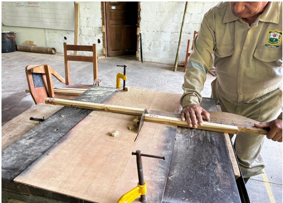
Figura 28. Habilitación de probetas de flexión estática.
