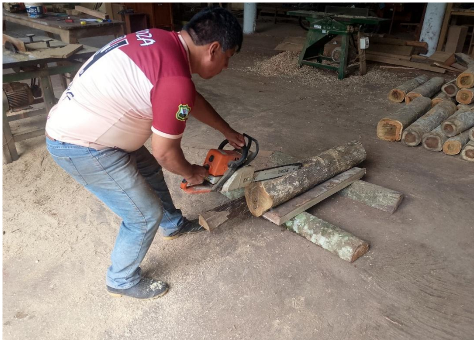
Figura 18. Aserrado de trozas.
