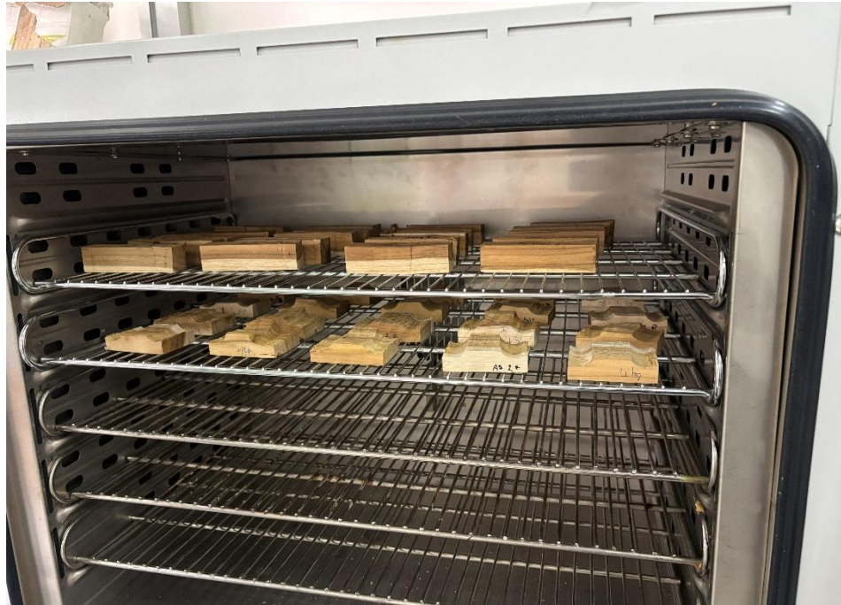
Figura 43. Secado al horno para determinación del contenido de humedad.
