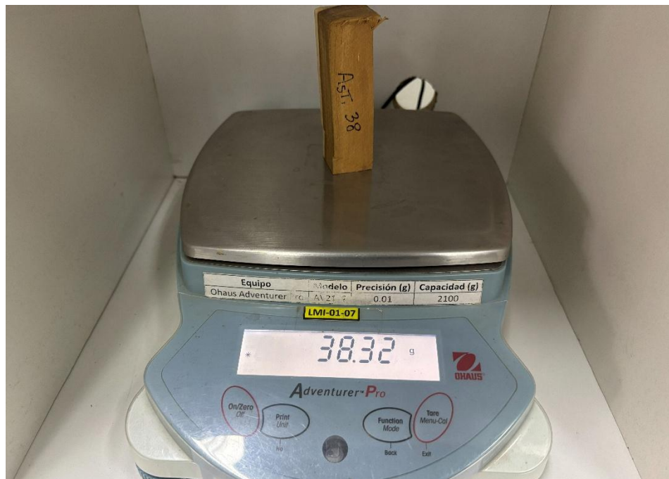
Figura 40. Pesado de probeta de compresión luego del ensayo.
