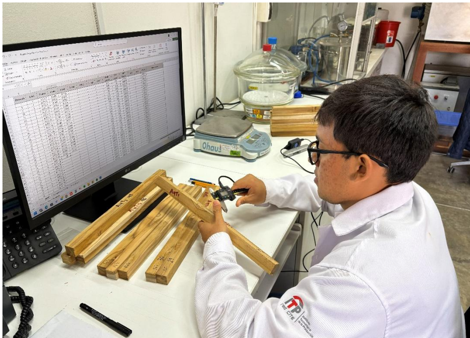
Figura 32. Medición y registro del centro de las probetas de flexión estática.
