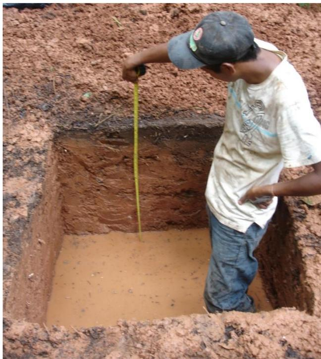
Figura 21. Medición de la profundidad de la napa freática.
