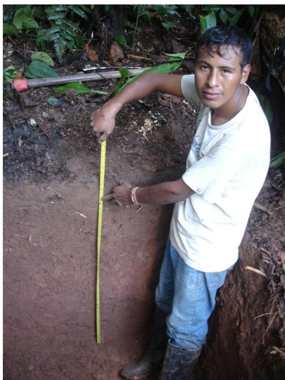
Figura 20. Apertura y medición de calicata.
