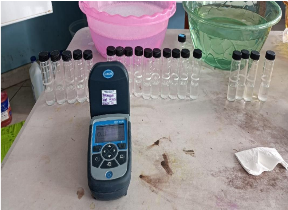
Figura 67. Medición del Manganeso en el Dr900
