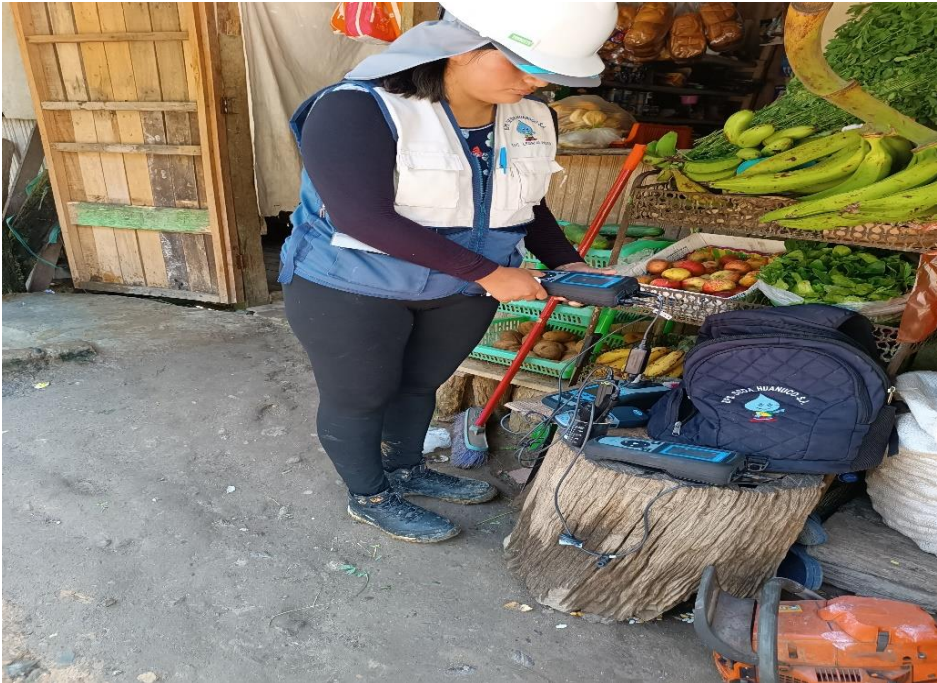
Figura 33. Evaluación de cloro, turbidez, Ph, conductividad en campo.
