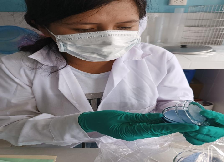
Figura 55. Lectura de las bacterias coliformes termotolerantes o fecales UFC/100 ml a 44.5°C
