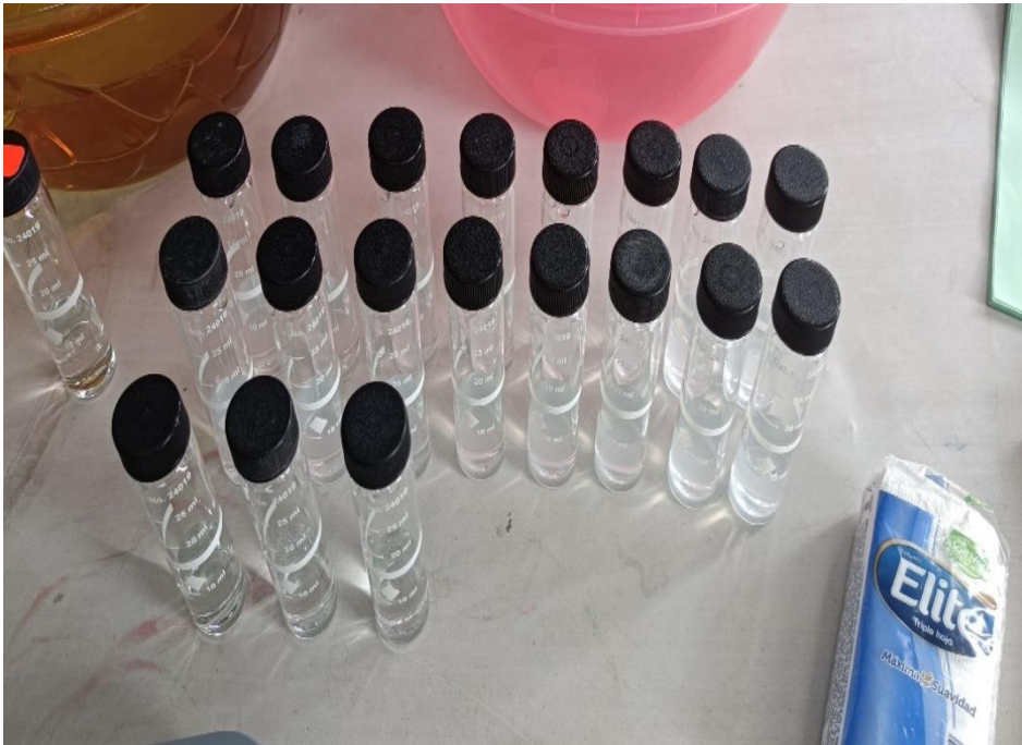
Figura 63. Medición de sulfato en las muestras
