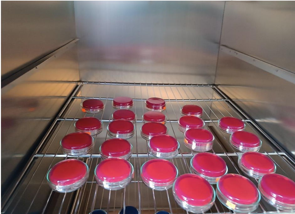
Figura 51. Incubación de las bacterias escherichia coli UFC/100 ml a 44.5°C durante 24 horas
