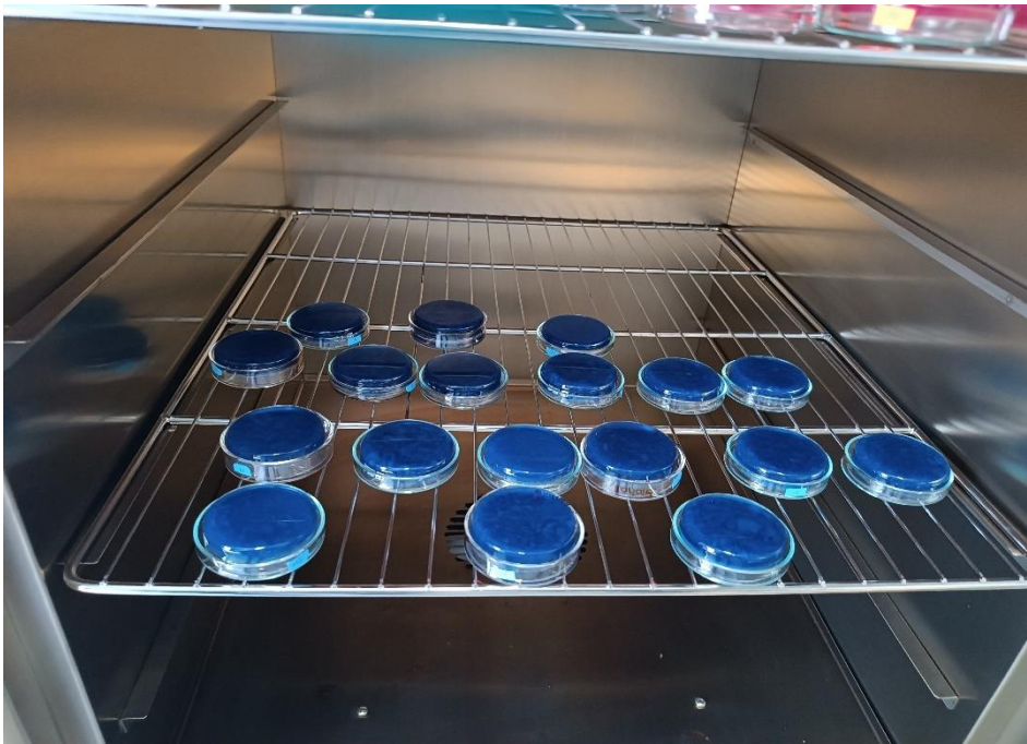
Figura 52. Incubación de las bacterias coliformes termotolerantes o fecales UFC/100 ml a 44.5°C durante 24 horas
