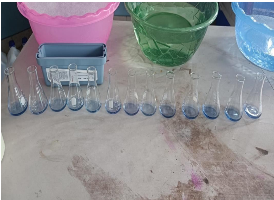
Figura 60. Dureza después de la Titulación y el conteo de gotas
