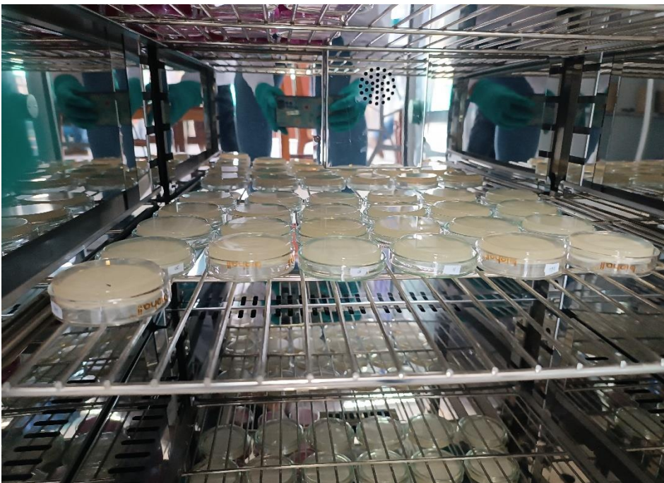
Figura 54. Incubación de las bacterias Heterotróficas UFC/100 ml a 35°C
