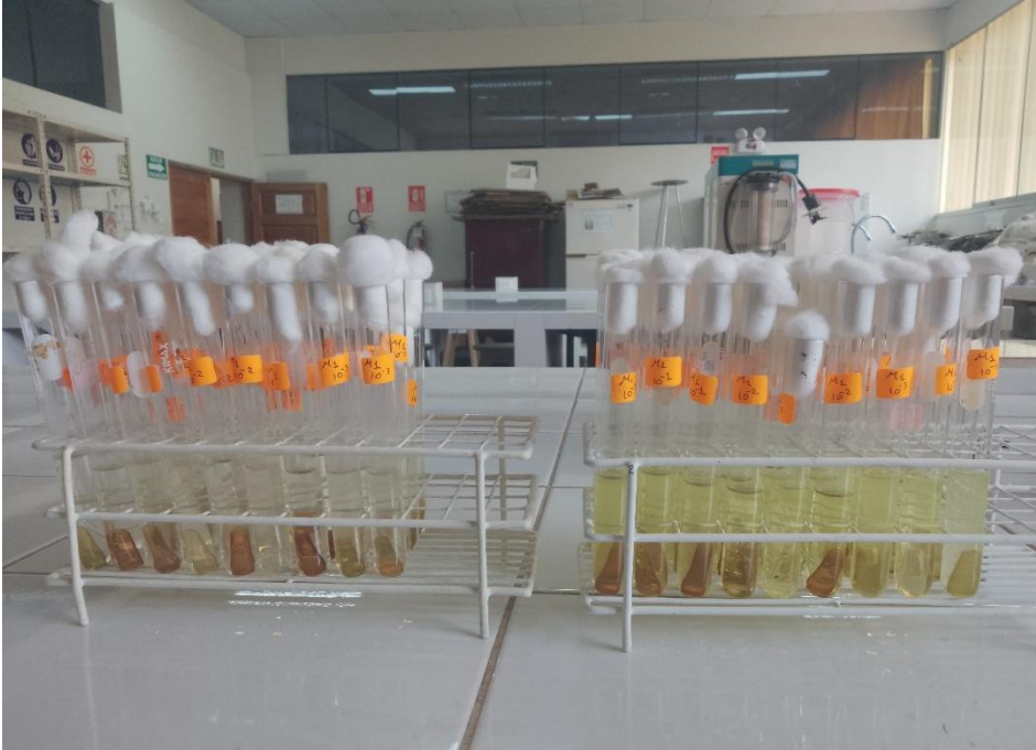
Figura 45. Conteo presuntivo de Coliformes totales.
