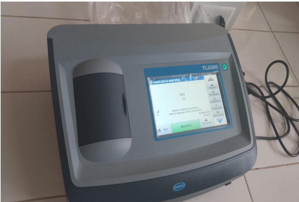
Figura 40. Medición de turbiedad.
