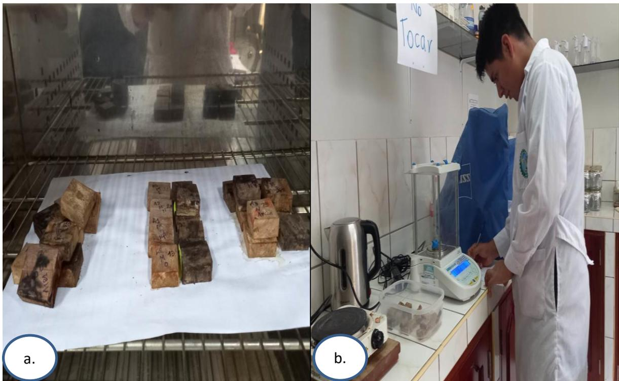
**Figura 10.** Evaluación de probetas: a. Secado en la estufa. b. Registro del peso final.
