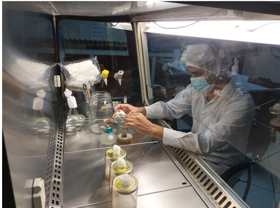
**Figura 28.** Colocación de las probetas esterilizadas en los frascos de ambas colonias de hongos.
