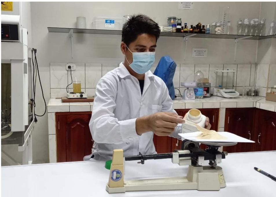
**Figura 24.** Pesado de 100 g de EMA en la balanza granatoria.
