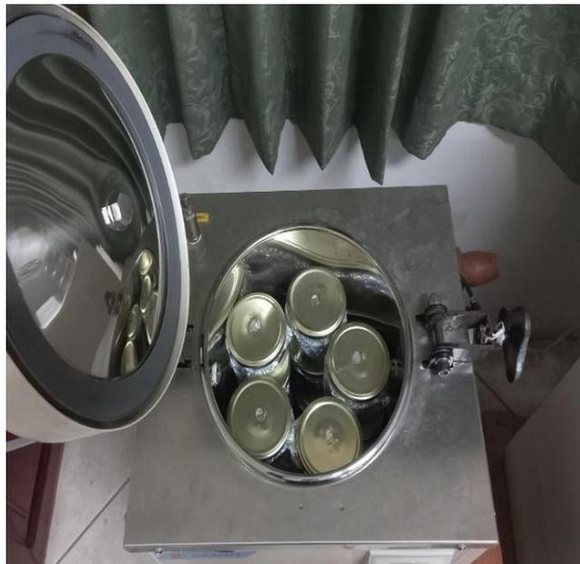
**Figura 7.** Esterilización de las probetas en la autoclave.
