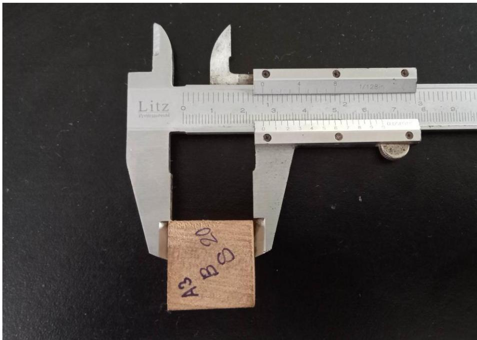
**Figura 22.** Medición de las probetas con vernier.
