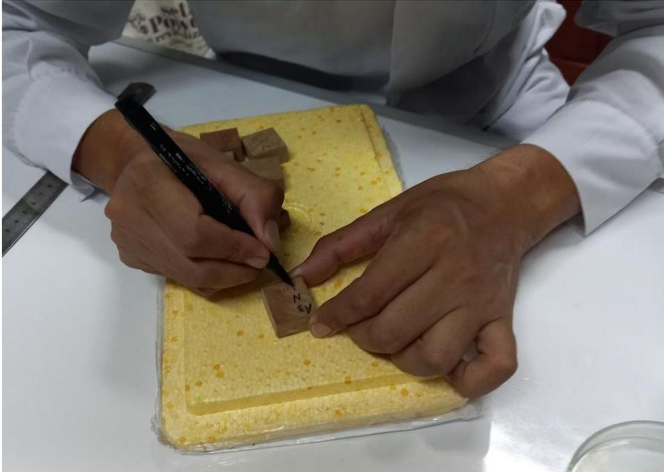
**Figura 21.** Codificación de las probetas según el método cruciforme.
