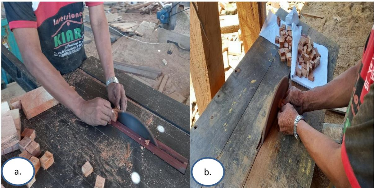
**Figura 5.** Obtención de muestra. a. Elaboración de probetas en sierra circular. b. Rectificación de probetas con lija de grano de 120.
