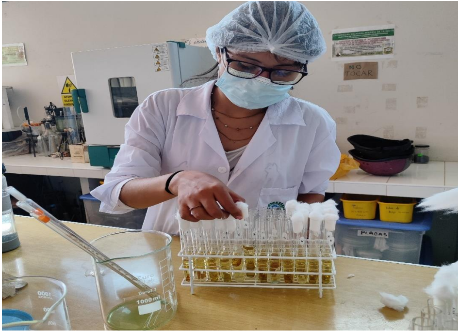
Figura 23. Preparado de la solución en los tubos de ensayo para los coliformes totales y termotolerantes – Escherichia coli .
