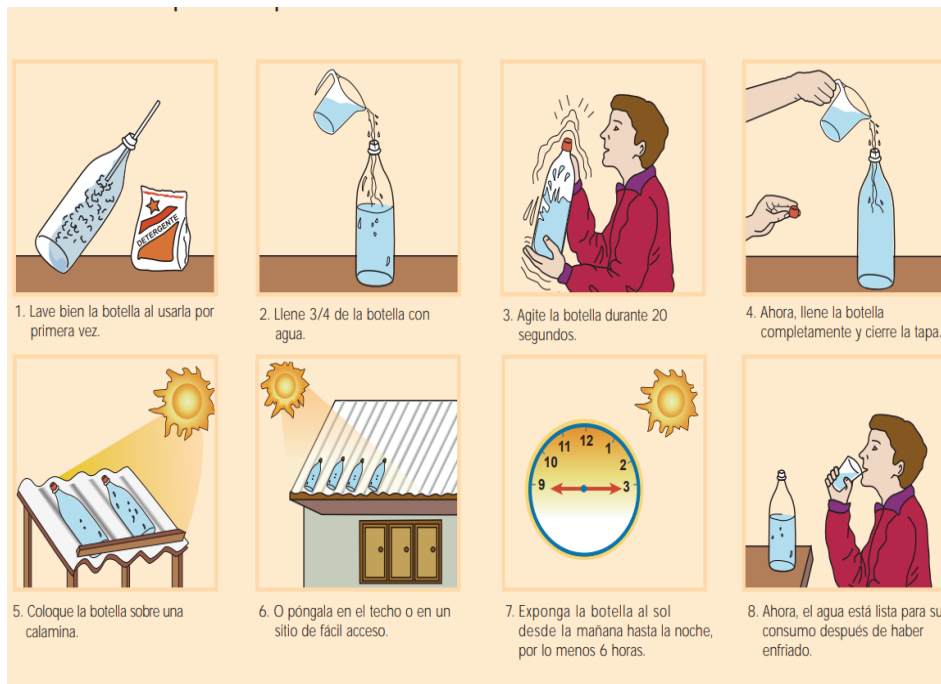
Figura 1. Procedimiento del método SODIS
