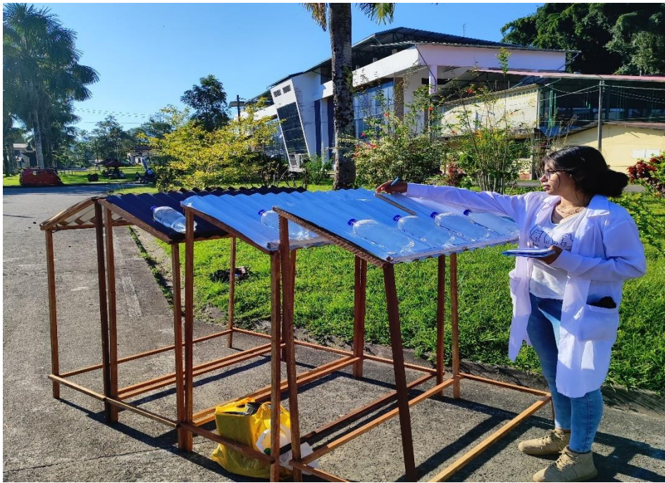
Figura 31. Puesta en marcha el sistema de desinfección Solar
