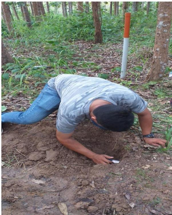
Figura 23. Densidad aparente del suelo en un sistema de plantaciones con Eucalipto.
