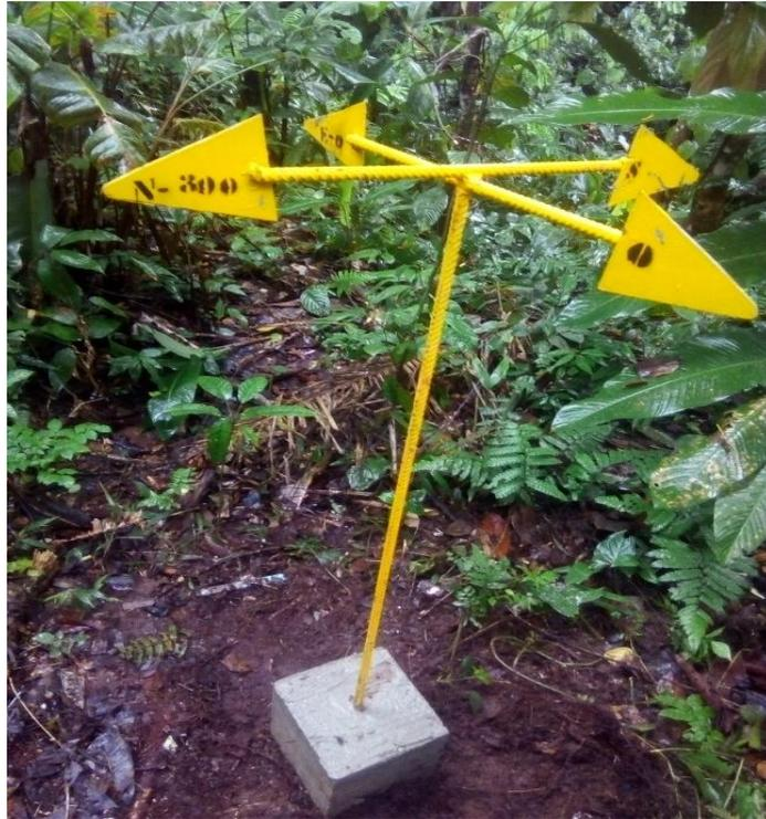
Figura 24. Instalación de hito N° 2
