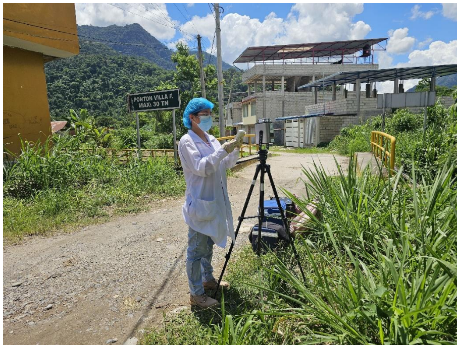
Figura 21. Medición de la temperatura y humedad relativa en el PM0.
