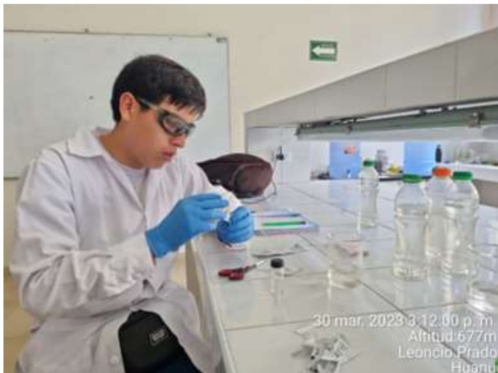
Figura 33. Preparación de las muestras de agua para la determinación de nitritos y nitratos
