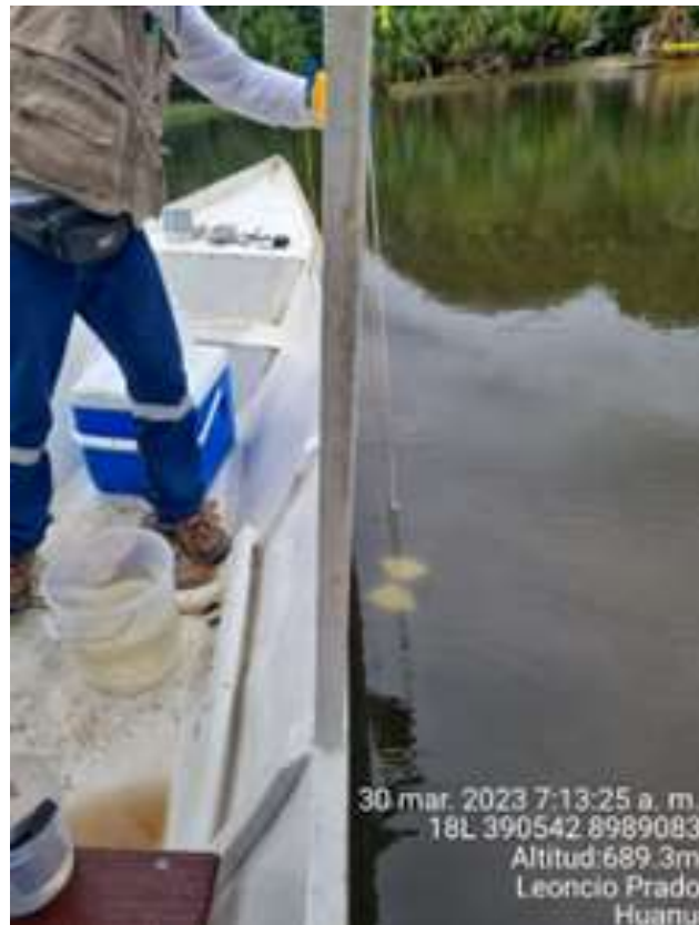
Figura 28. Toma de medición con un flexómetro para la penetración luminosa (Claridad)
