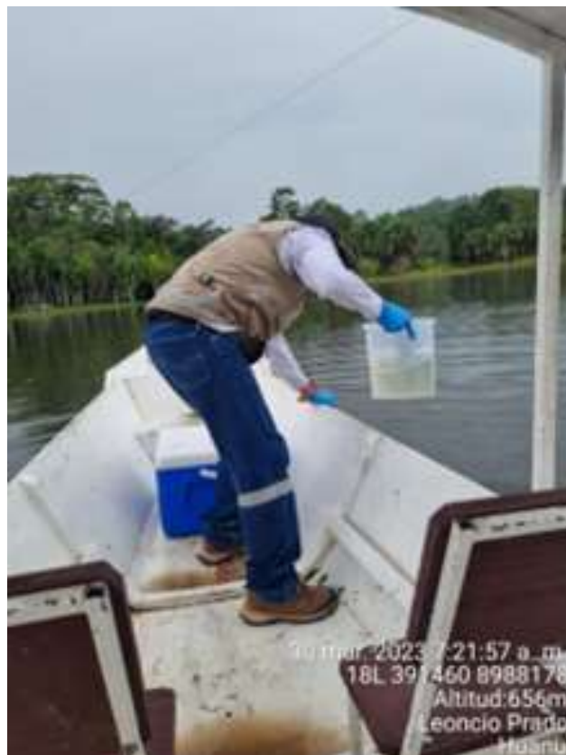
Figura 19. Toma de muestra del cuerpo de agua a medio metro con un balde transparente
