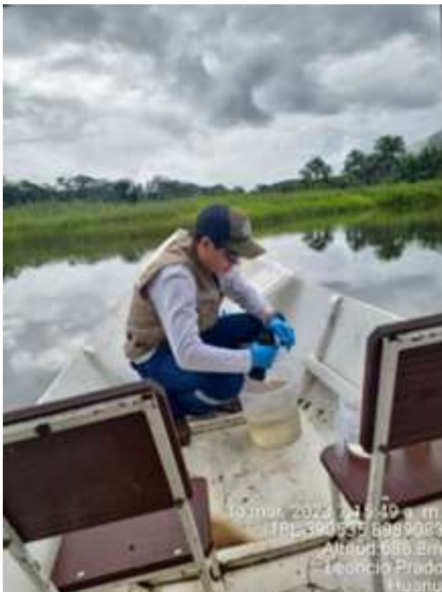
Figura 21. Toma de muestra para el análisis de DBO5, recipiente de vidrio color oscuro
