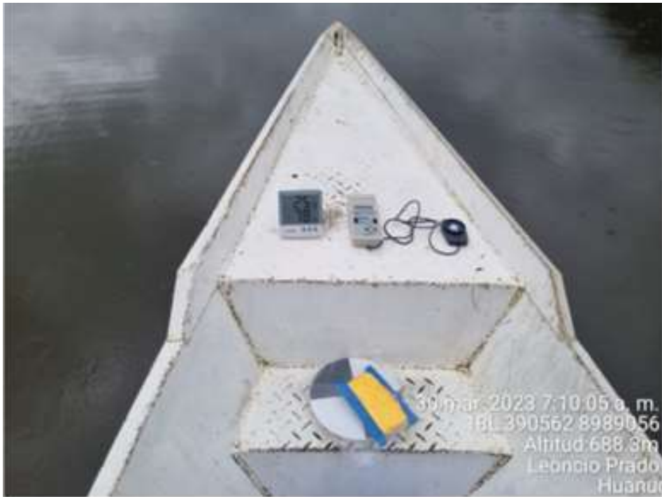
Figura 16. Control de parámetros externos como T°, humedad y la iluminación
