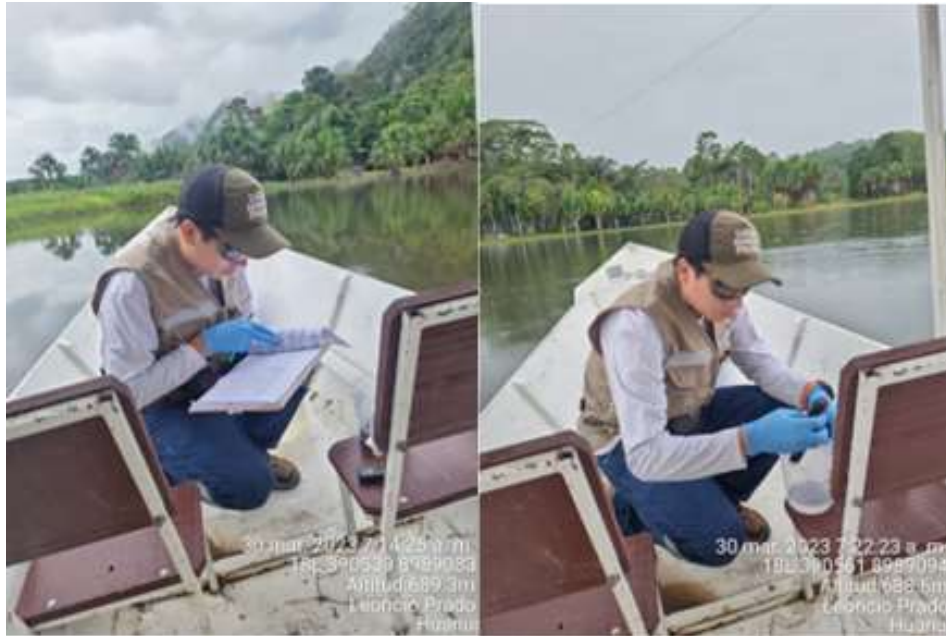
Figura 26. Toma de datos en campo con el multiparámetro Hi98129 de T°, PH y TDS
