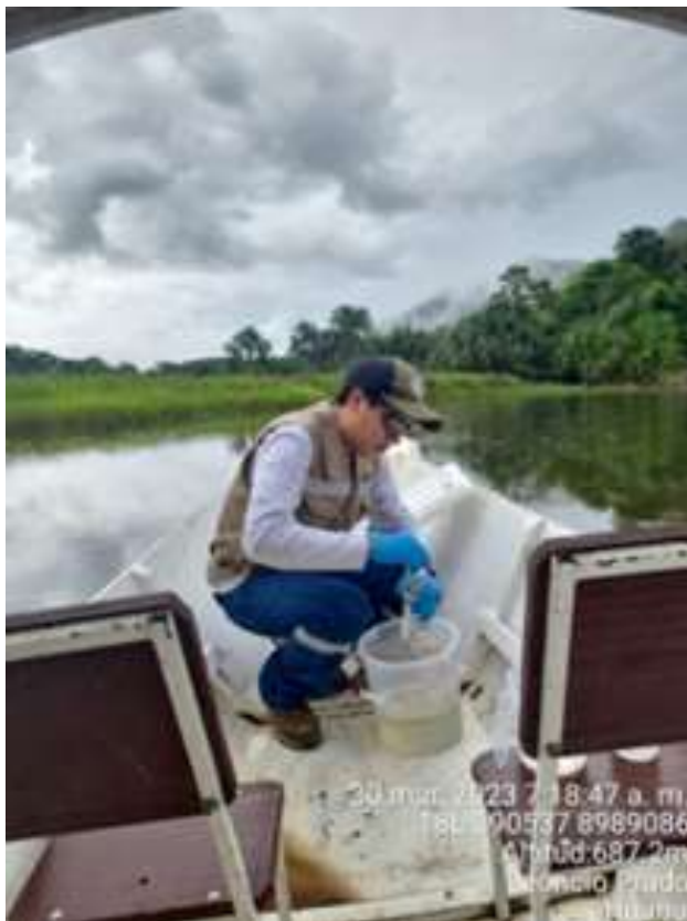
Figura 23. Toma de muestra para la determinación de fosforo.
