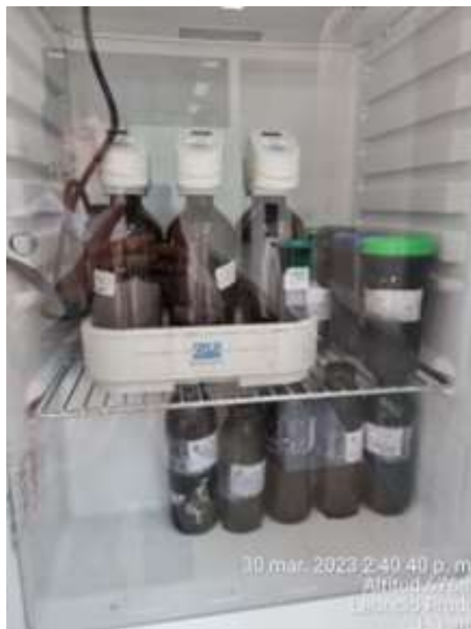
Figura 31. Toma de medición de oxígeno disuelto y DBO5 para luego ser colocada en la cámara a 20 C°
