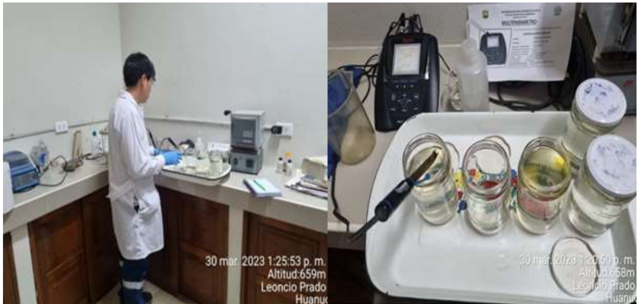
Figura 30. Toma de medición de conductividad eléctrica
