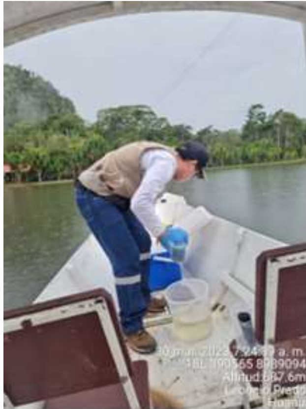
Figura 22. Toma de muestra para el análisis de Fisicoquímico, recipiente de vidrio transparente
