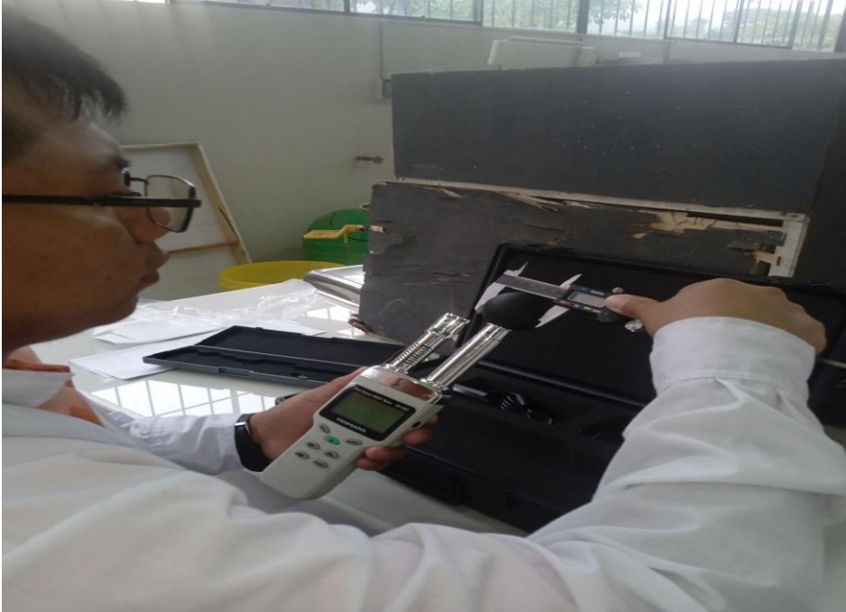
Figura 35. Medición del diámetro del sensor de temperatura del globo con la regla vernier.
