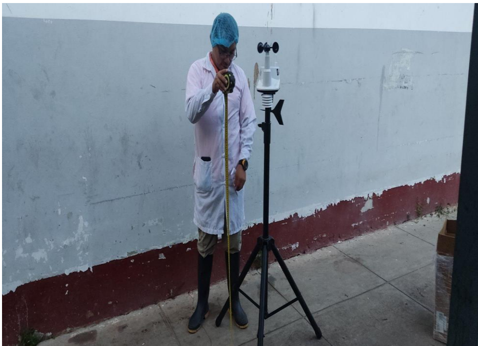
Figura 24. Medición de altura para instalación de anemómetro.
