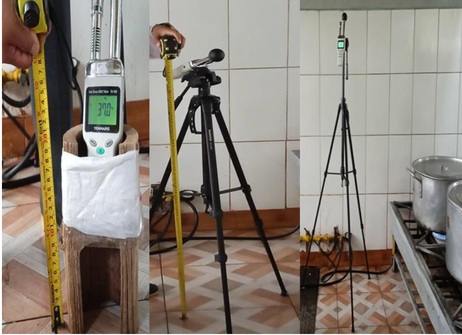
Figura 25. Medición de altura para la instalación del medidor de estrés térmico.
