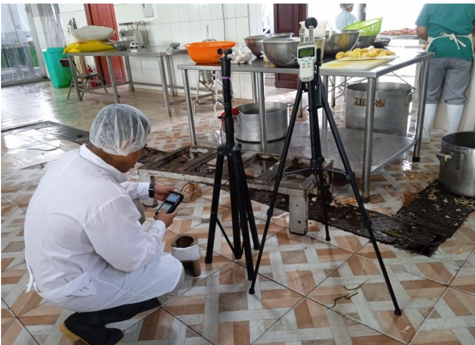
Figura 34. Medición de parámetros ambientales en el área de picado.
