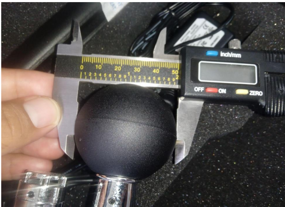
Figura 36. Medición del diámetro del sensor de temperatura del globo a mayor escala.
