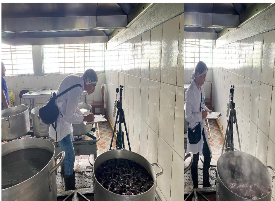
Figura 42. Medición de parámetros ambientales a la altura de 110 cm con el apoyo de los estudiantes Ingeniería ambiental del noveno ciclo.
