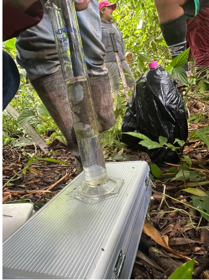
Figura 17. Medición del volumen verde de la sección de rama de la especie.
