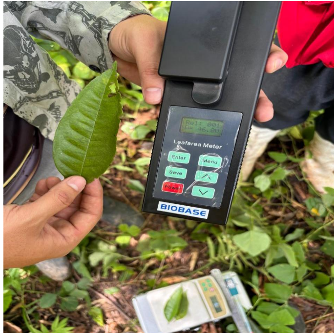
Figura 15. Medición del área foliar con equipo electrónico para tal fin.
