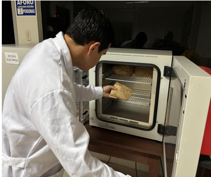
Figura 21. Retirado de muestras para su evaluación de peso seco.
