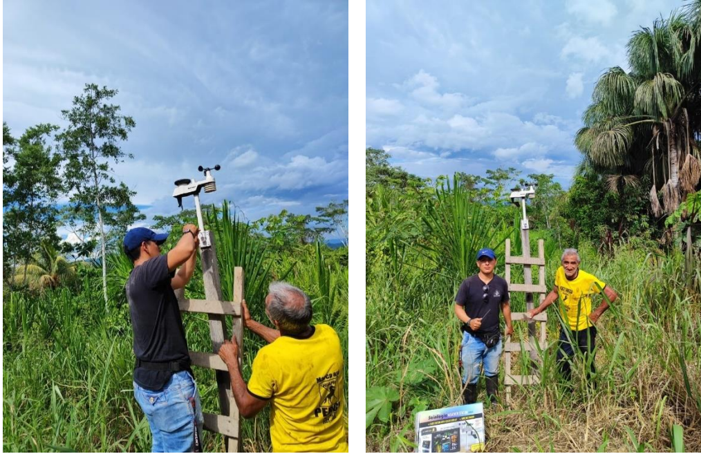
Figura 127. Instalación de la estación meteorológica de estudio “La Morada”.
