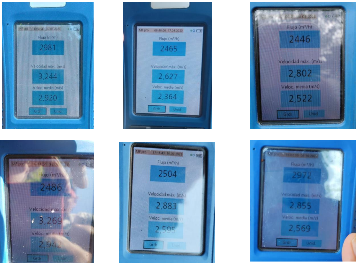
Figura 91. Imágenes del caudalímetro con resultados de los caudales aforados en el canal de riego.
