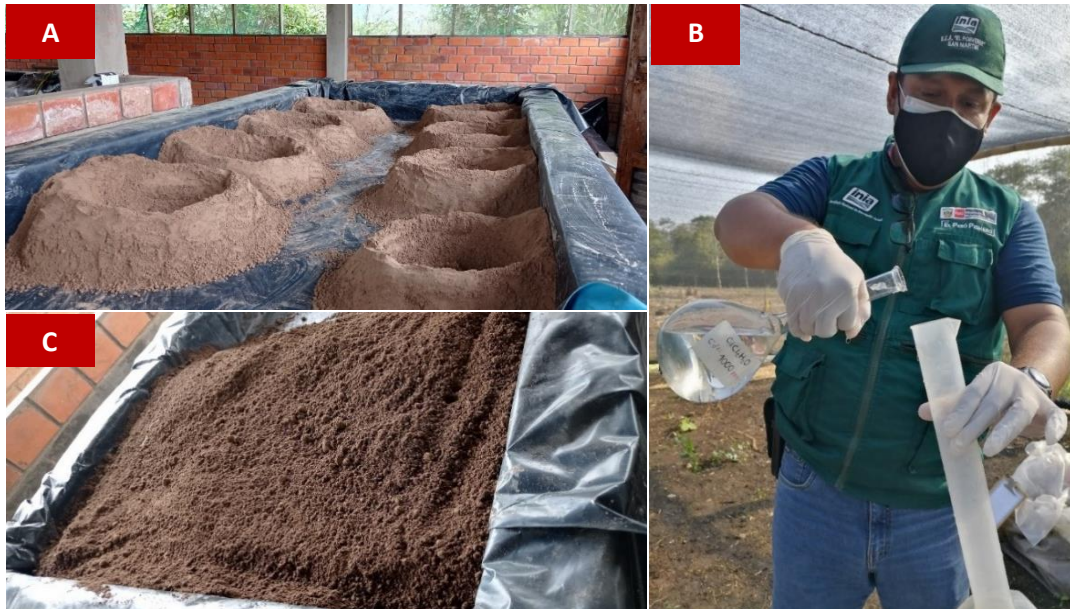
Figura 27. Contaminación de sustrato, a) Formación de rumas, b) Adición de \text{CdCl}_2\cdot\text{H}_2\text{O} , c) Sustrato contaminado con Cd para posterior reposo.
