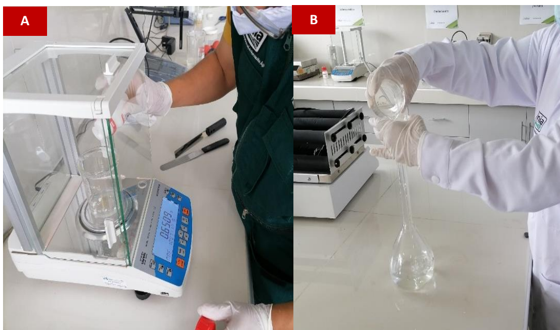
Figura 26. Elaboración de solución de Cd en ppm, a) Pesado del CdCl 2 H 2 O, b) Dilución del CdCl 2 H 2 O en agua destilada.
