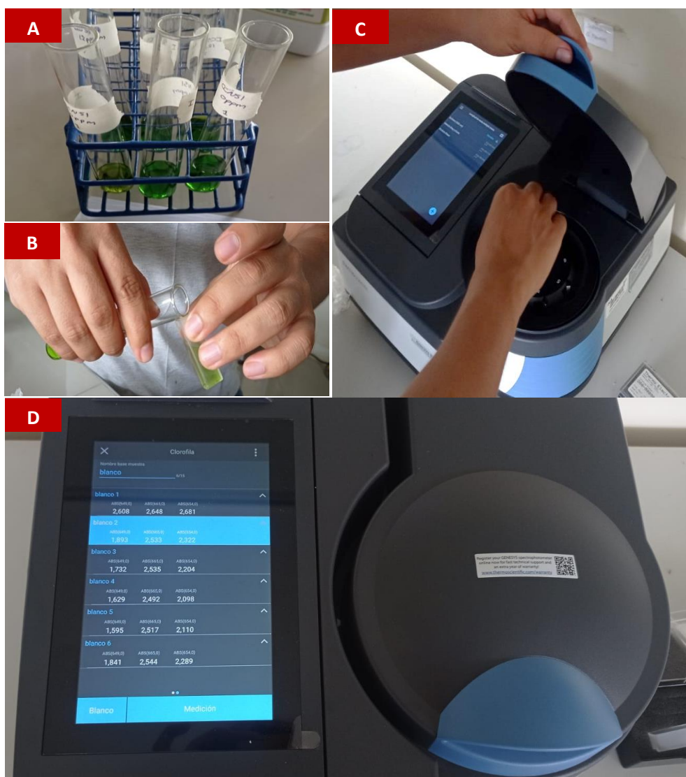
Figura 38. Lecturas de muestras foliares, a) Disposición en tubos de ensayo, b) Trasferencia a cubeta del espectrofotómetro UV visible, c) Introducción de cubetas al espectrofotómetro UV visible, d) Lectura de absorbancia mediante espectrofotómetro UV visible.
