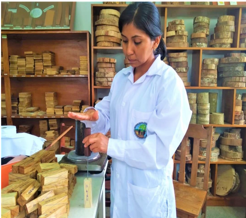
Figura 38. Colocación del punzón en la sección transversal de la probeta.
